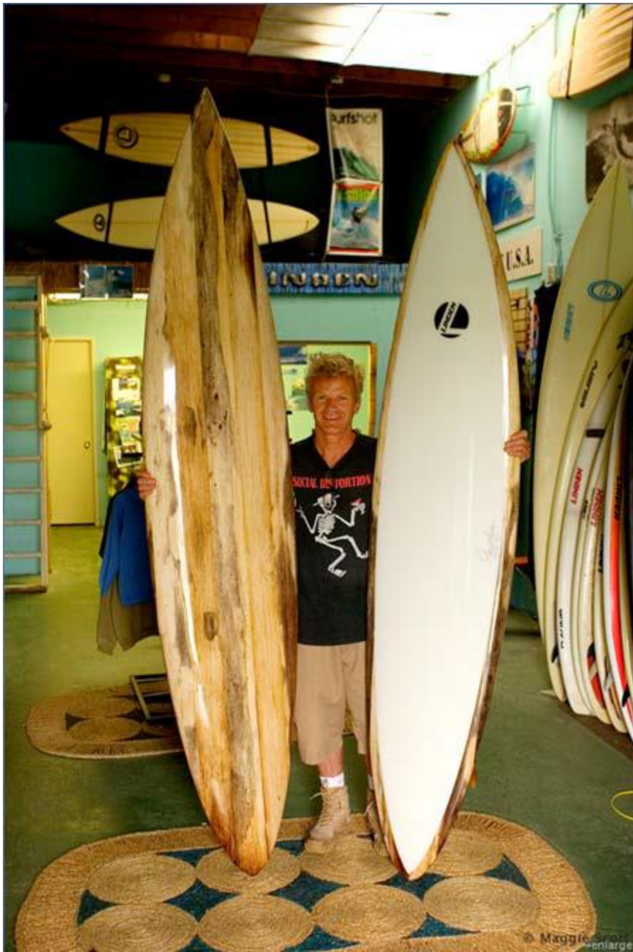
Slika 5.1 Daska za surfanje s vlaknima agave [28]
