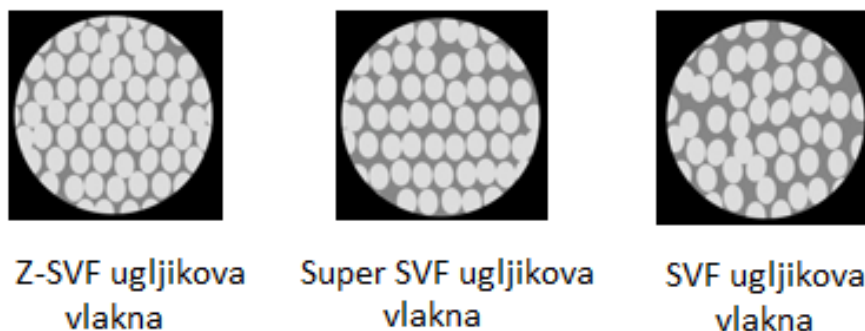
Slika 4.3 Prikaz različitih udjela ugljikovih vlakna prema udjelu smole [17]
