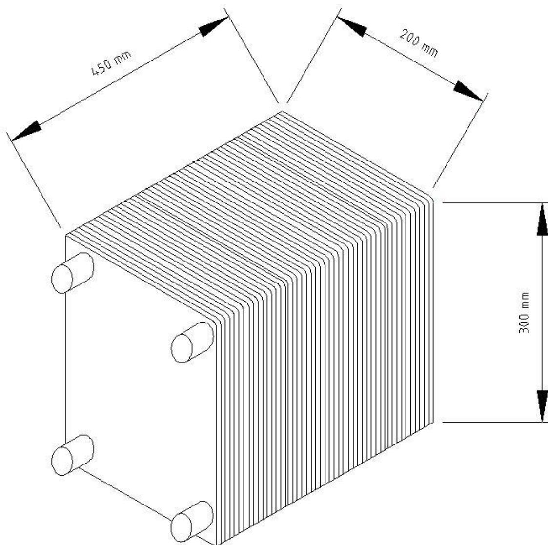
*Slika 24. Dimenzije pločastog isparivača*
