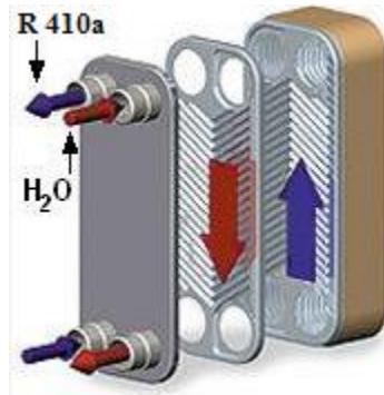
*Slika 23. Pločasti kompaktni isparivač*
