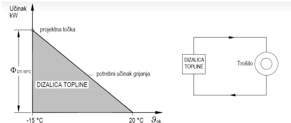
*Slika 2. Monovalentni način rada dizalice topline [3]*
