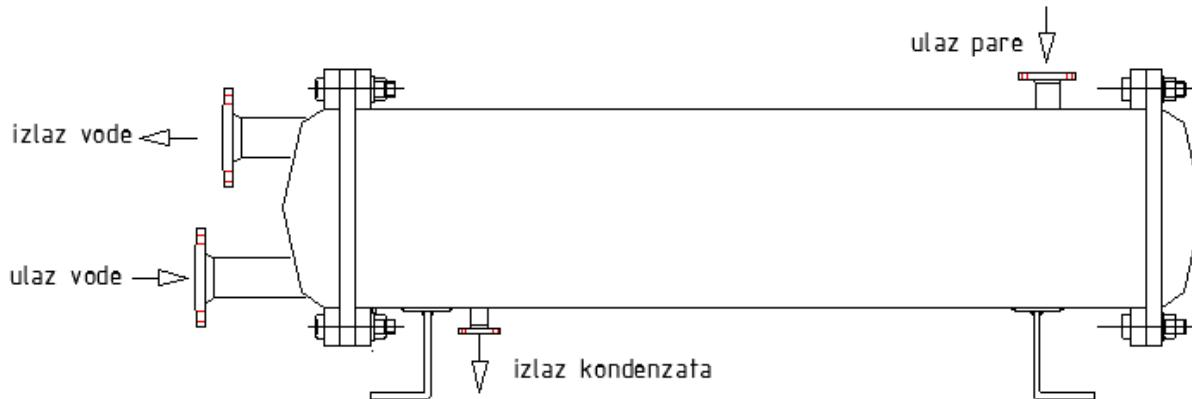
*Slika 18. Shematski prikaz kondenzatora s cijevima u plaštu*
