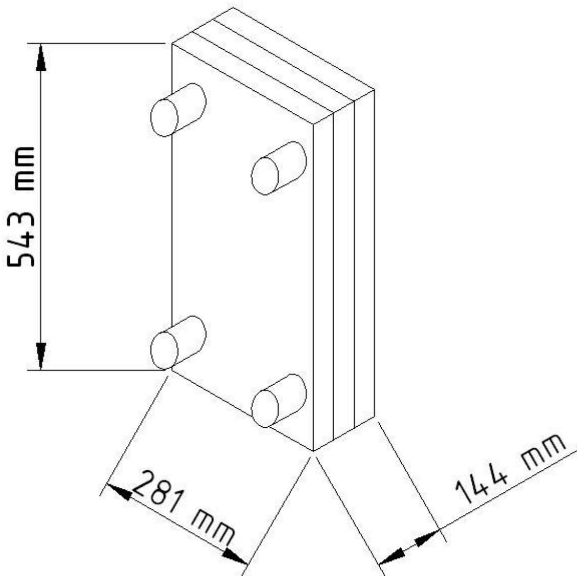
Slika 22. Pločasti kondenzator – dimenzije
