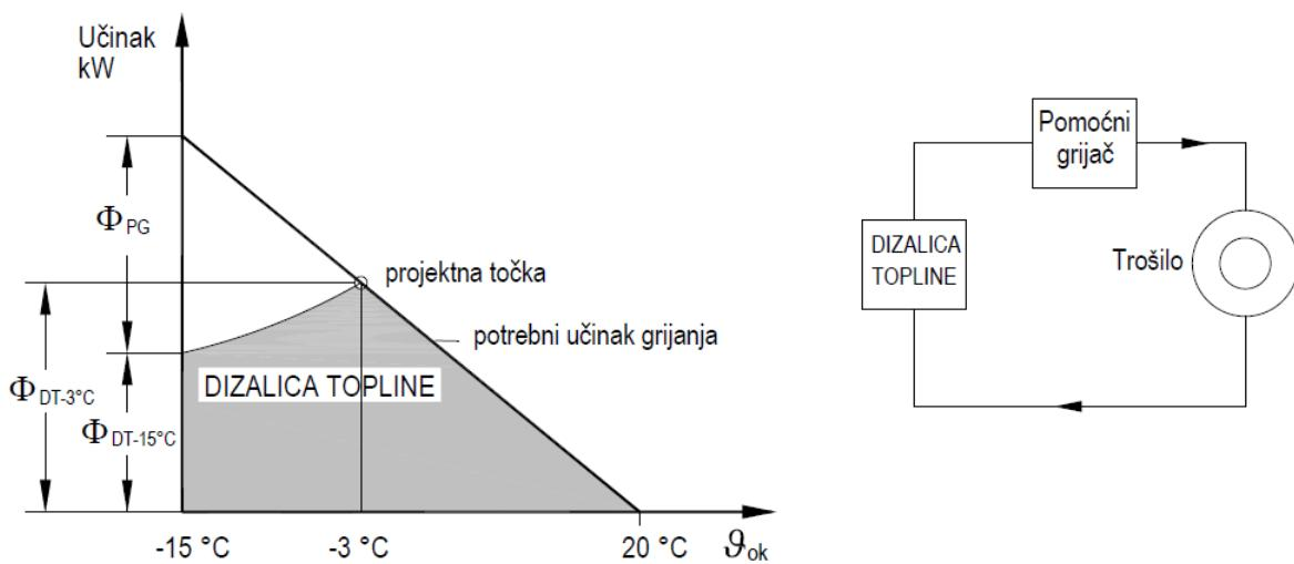
Slika 3. Bivalentno-paralelni način rada dizalice topline [3]
