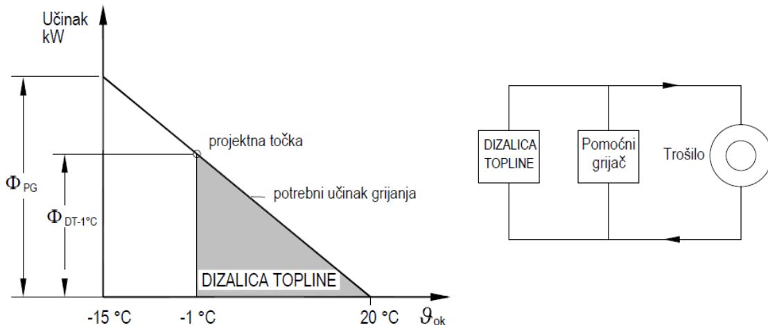
Slika 4. Bivalento-alternativni način rada dizalice topline [3]
