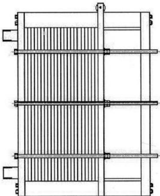
Slika 21. Shema pločastog kondenzatora
