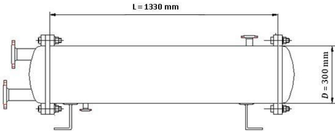
*Slika 20. Dimenzije kondenzatora*
