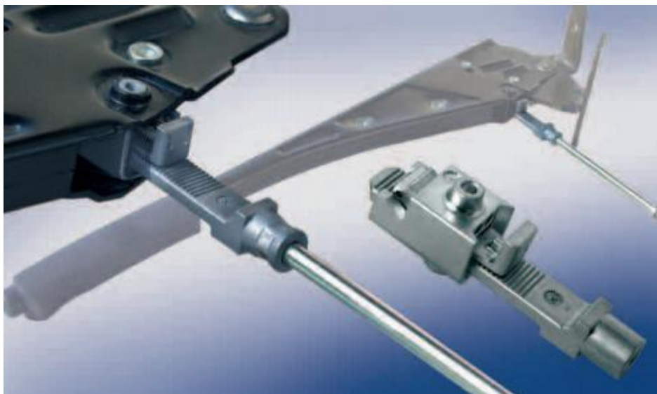
Slika 4.21. Jedinica za podešavanje ručne kočnice [28]
