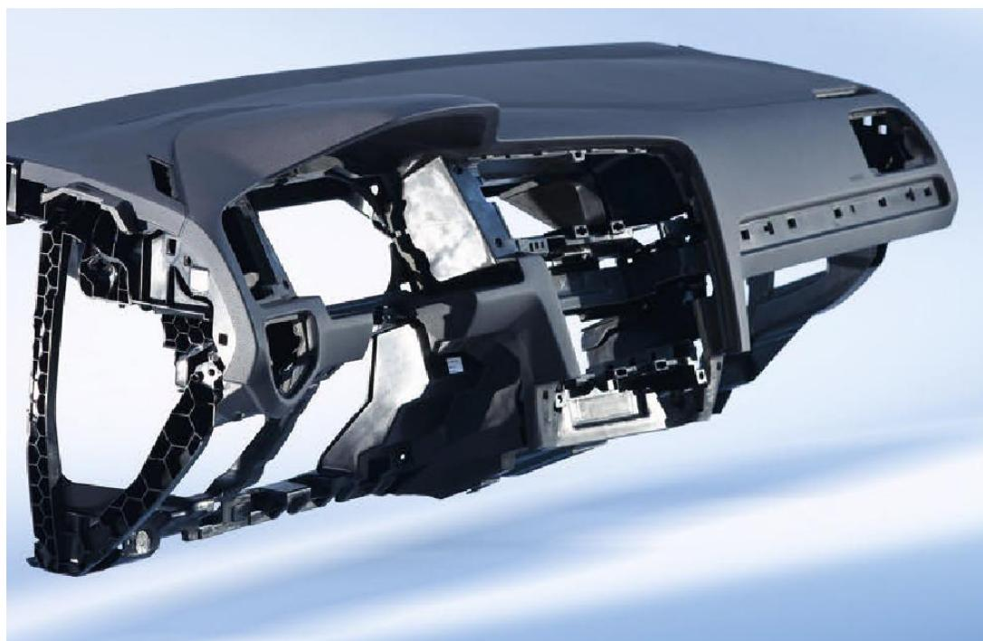
Slika 4.13. Okvir ploče s instrumentima VW GOLF 7 proizvede postupkom *MuCell* [18]
