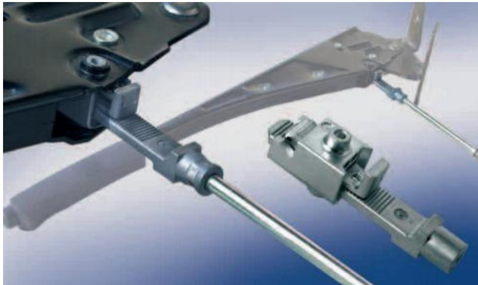
Slika 4.21. Jedinica za podešavanje ručne kočnice [28]
