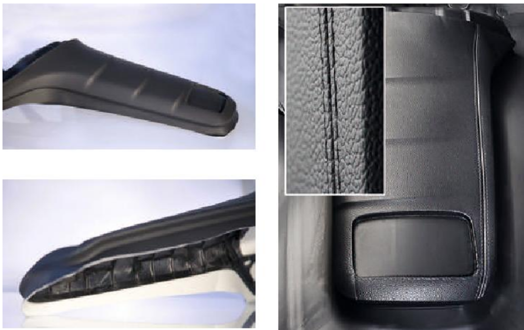
Slika 4.22 Upravljačka ploča proizvedena postupkom Varysoft [30]
