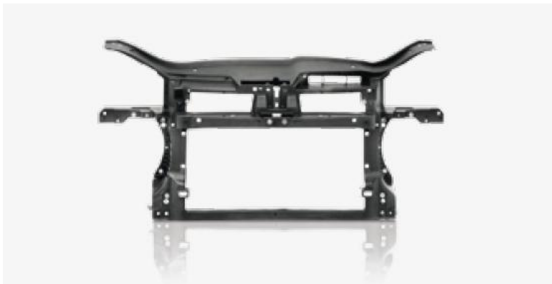
Slika 4.4. Vlaknima ojačan nosač konstrukcije upraljačke ploče [13]
