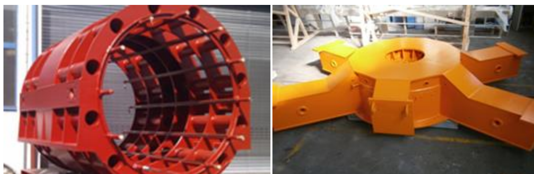
Slika 5. Kućište statora i zvijezda rotora [7]
