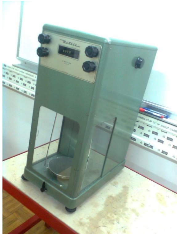
Slika 5.7. Vaga "Mettler" Zurich (Laboratorij za tribologiju FSB-a)
