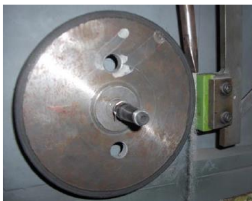
Slika 5.5. Detalj uređaja: kotač, gumena traka, mlaznica, držač uzorka [13]
