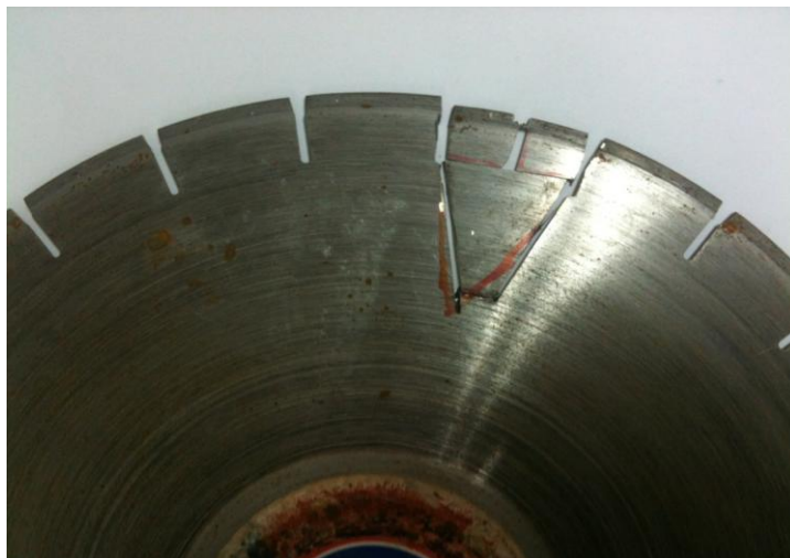
Slika 23. Prikazuje izrezan komad rezne ploče, pomoću kružne pile za željezo
