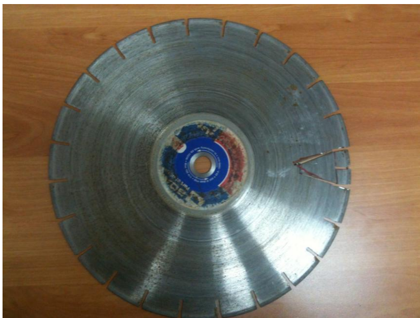
Slika 19. Prikaz cijele rezne ploče promjera 35 cm za beton i armirani beton
