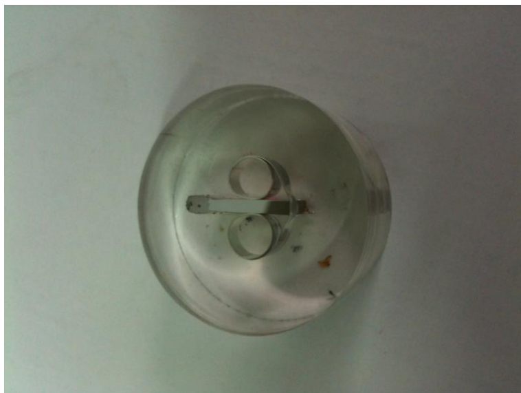
Slika 24. Uzorak spreman za metalografsku analizu
