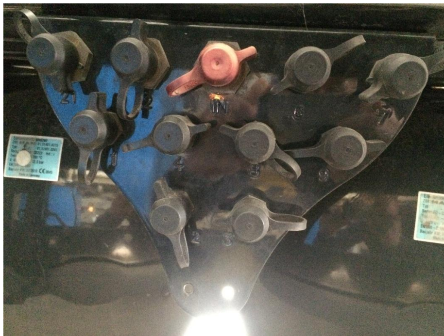
Slika 51. Kontrolni priključci spremnika zraka
