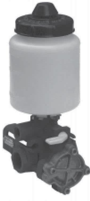
Slika 50. Primjer uređaja protiv smrzavanja kondenzata
