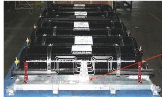
Slika 7.3. Faber cilindar aluminijski s ugljičnim vlaknima
