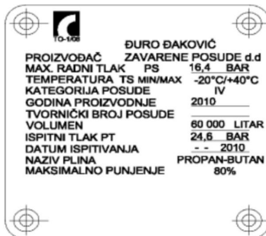
Slika 6.7. Prikaz pločice spremnika za ukapljeni prirodni plin
