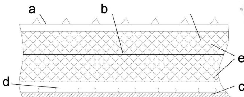
**Slika 5.8. Izolacija sustava Technigaz – Mark III**
