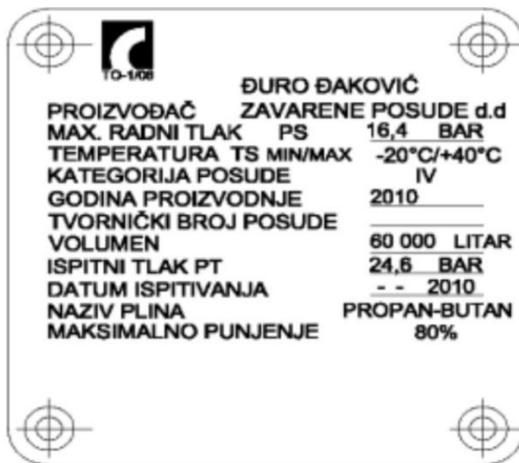
Slika 6.7. Prikaz pločice spremnika za ukapljeni prirodni plin
