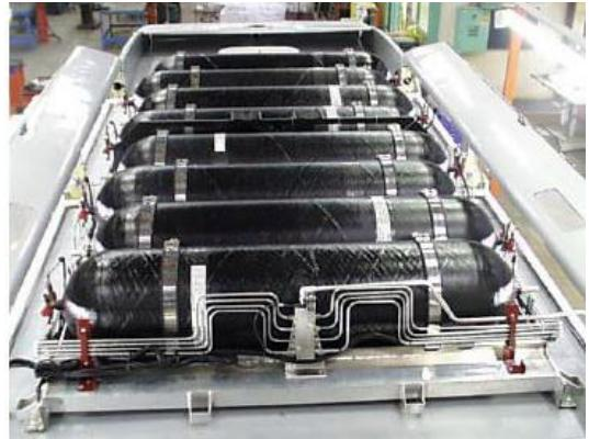
Slika 7.2. Faber cilindar čelični s ugljičnim vlaknima
