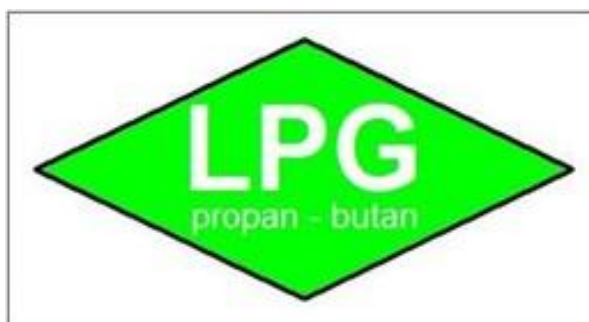
Slika 6.10. Naljepnica za vozila s ukapljenim naftnim plinom
