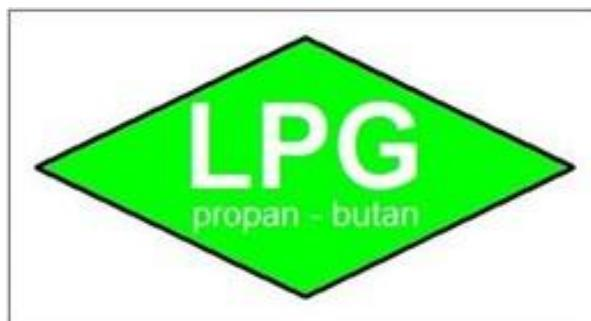
Slika 6.10. Naljepnica za vozila s ukapljenim naftnim plinom
