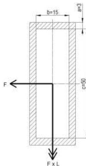
Slika 8.1. Poprečni presjek zavara
