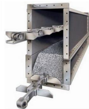
Slika 15. Lančani konvejer s povodnjem materijala [2]
