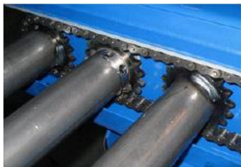
Slika 12. Valjčani konvejer, prijenos lancima [2]
