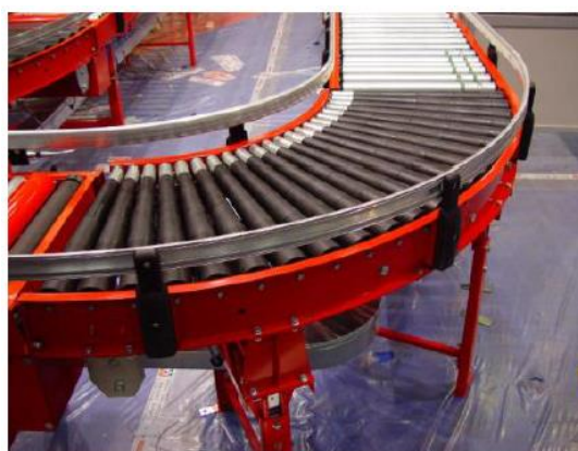
Slika 11. Zakrivljeni valjčani konvejeri [2]
