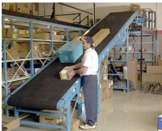
Slika 7. Ravni trakasti konvejer pod kutom [2]
