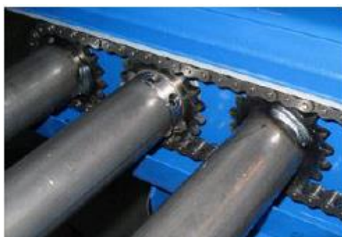
Slika 12. Valjčani konvejer, prijenos lancima [2]
