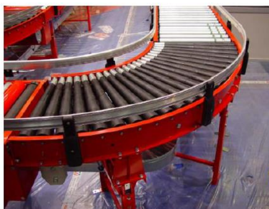
Slika 11. Zakrivljeni valjčani konvejeri [2]
