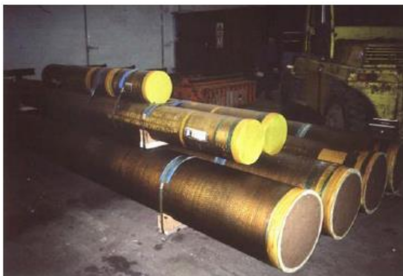
Slika 12. Privremena zaštita unutrašnjosti cijevi praškastim inhibitorima korozije [12]
