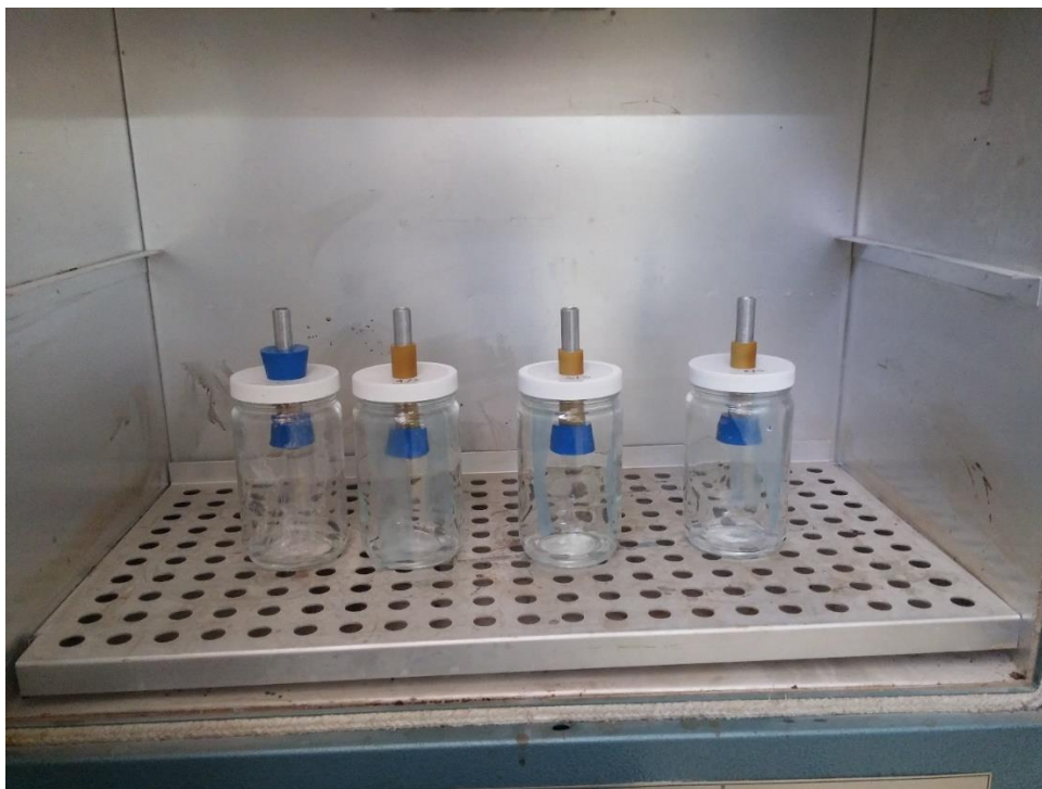
Slika 35. Oprema za ispitivanje u sušioniku na temperaturi od 40 °C
