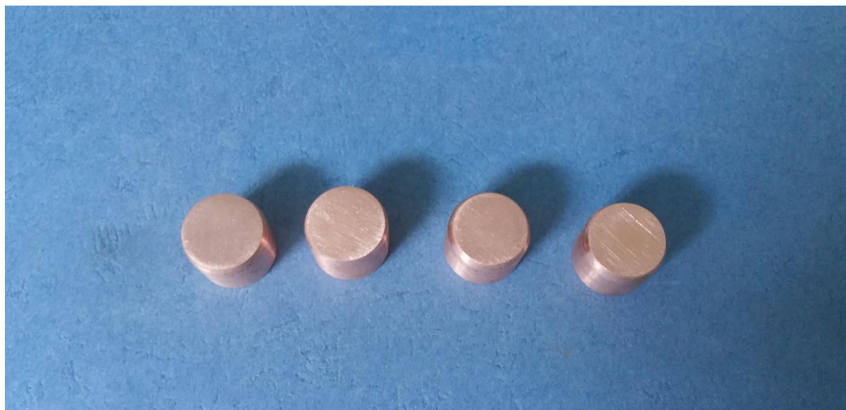
Slika 32. Uzorci od bakra promjera 10 mm
