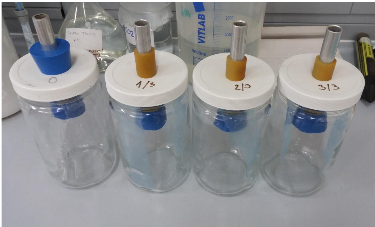
Slika 34. Posude sa VIA kompletiranim poklopcem i nalijepljenim PE folijama
