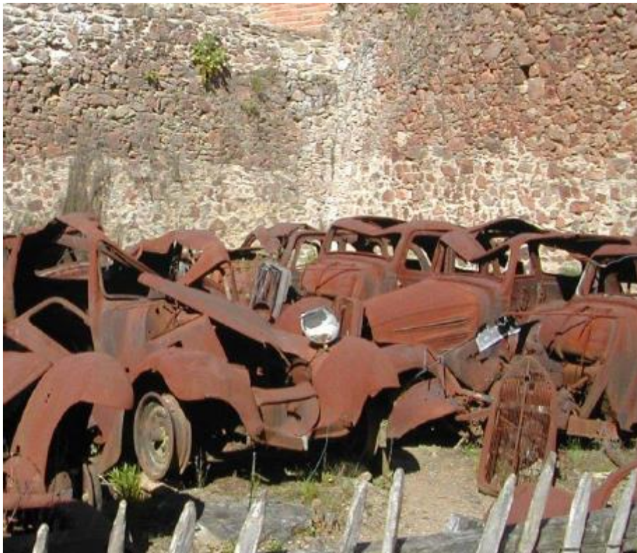
Slika 2. Primjer opće korozije [3]
