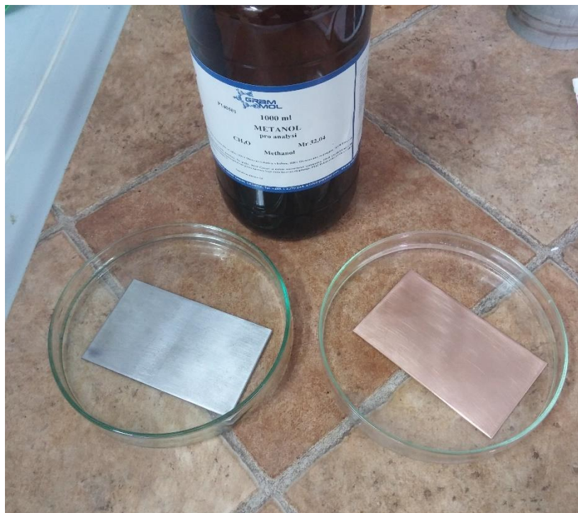
Slika 19. Uzorci uronjeni u metanol
