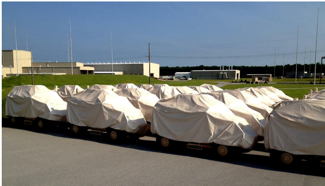
Slika 15. Primjena inhibitora korozije za zaštitu vojnih vozila [19]
