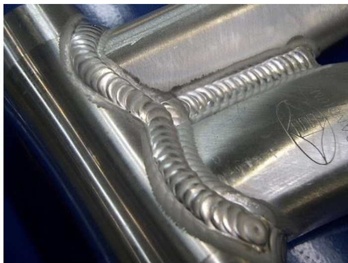
Slika 16 Zavareni spoj aluminija
