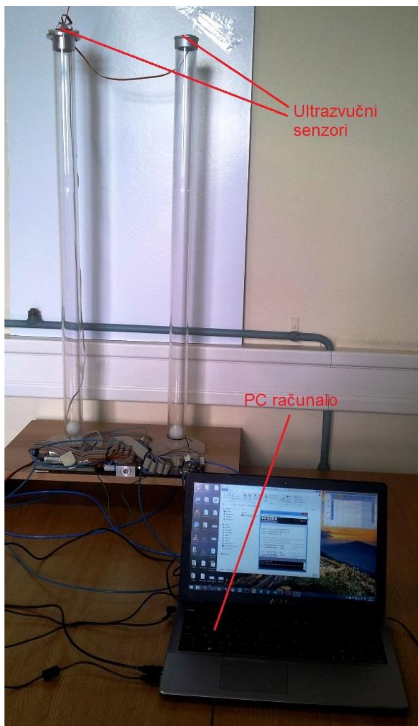
Slika 9. Nastavna maketa za regulaciju položaja loptice u vertikalnoj cijevi
