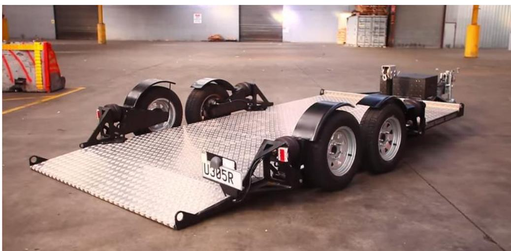
**Slika 3. Otvorena prikolica (hidraulična, s podesivom visinom)**
