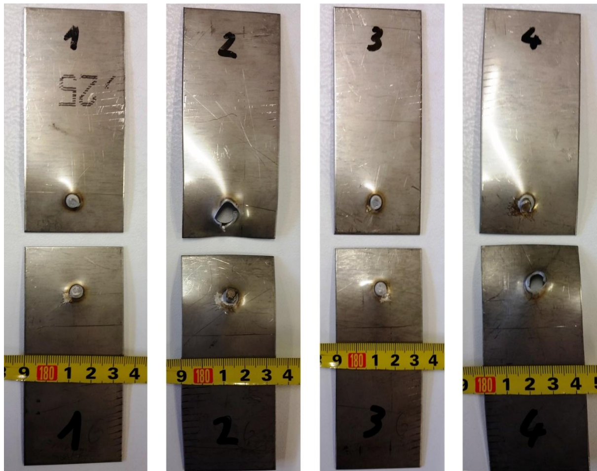
Slika 39. Uzorci 1-4 nakon ispitivanja na kidalici
