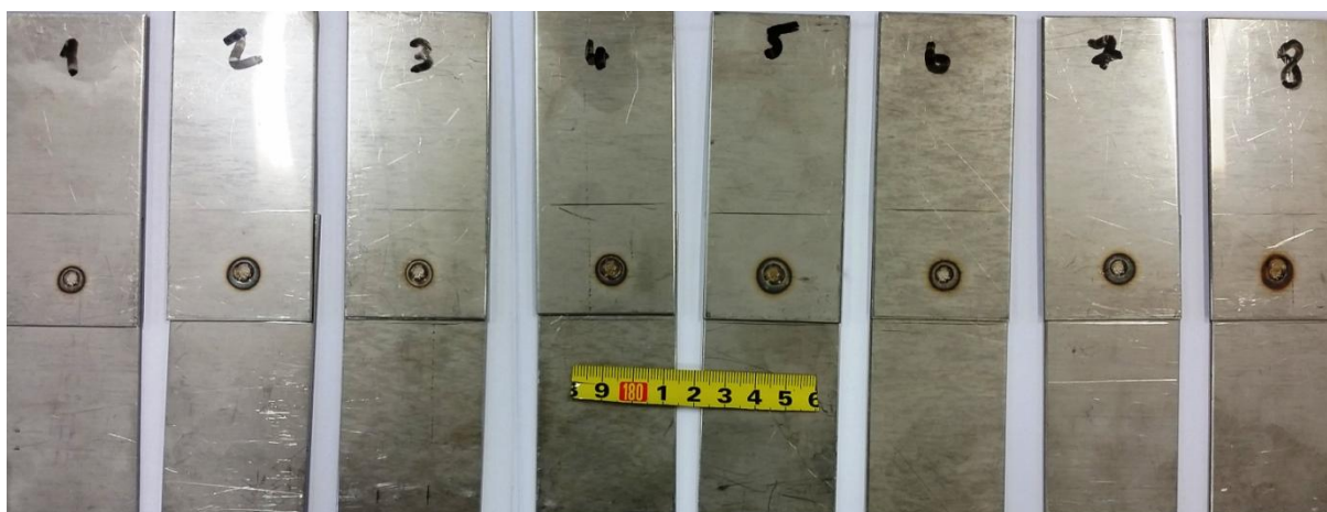
Slika 33.a Lice zavarene točke (kontakt: radni komad – gornja elektroda)
