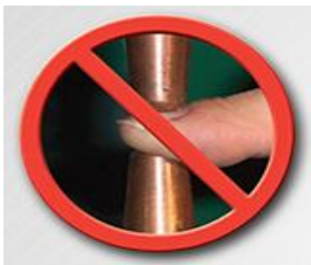
Slika 14. Prikaz ozljeđivanja na mjestu između dvije elektrode [18]
