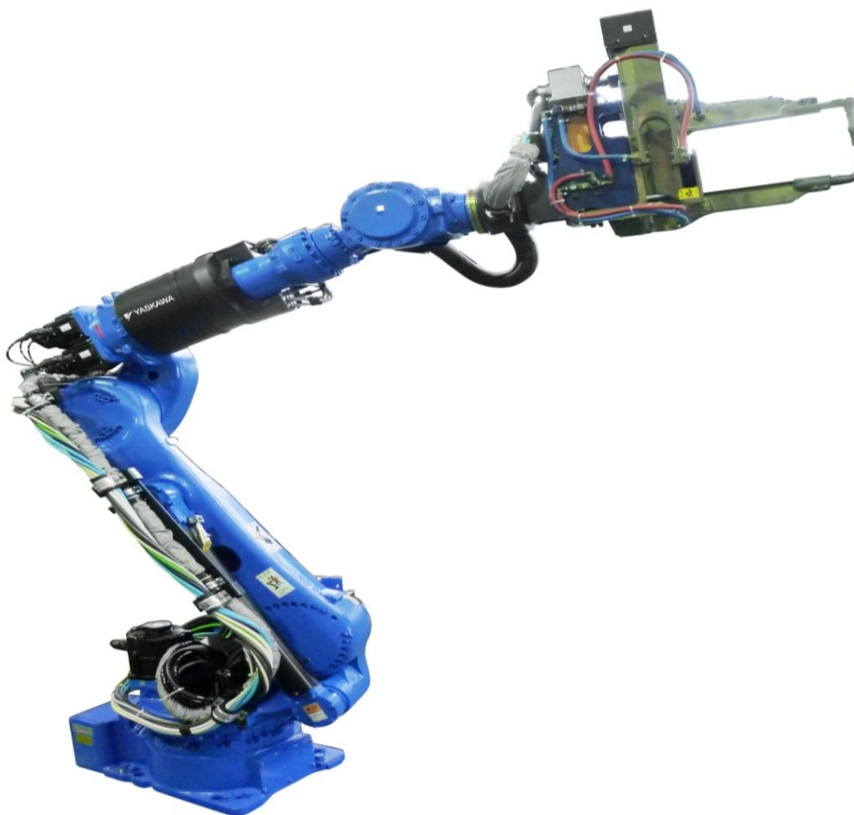
Slika 19. Robot za elektrootporno točkasto zavarivanje [26]
