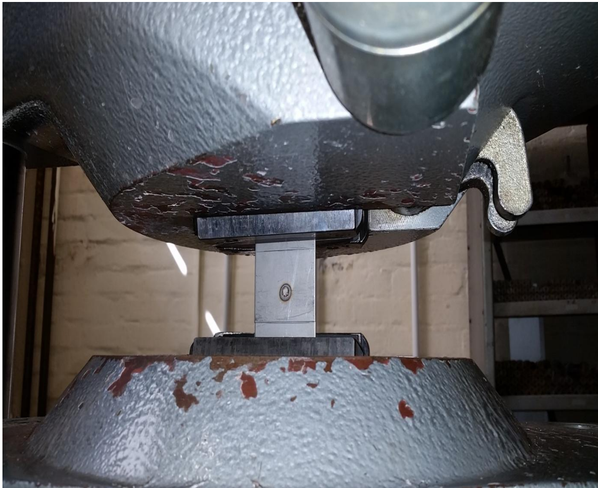
Slika 37. Ispitivanje čvrstoće zavara
