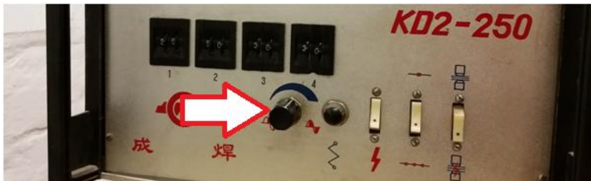
Slika 31. Reguliranje jakosti struje zavarivanja
