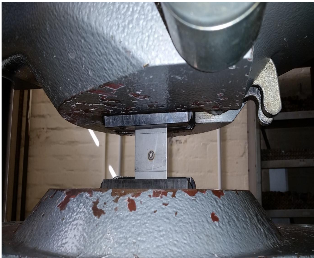
Slika 37. Ispitivanje čvrstoće zavara
