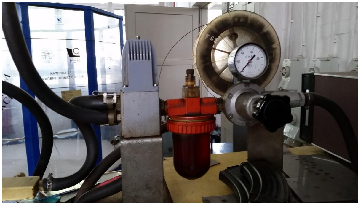
Slika 24. Manometar, nauljivač i elektromagnetski razvodnik
