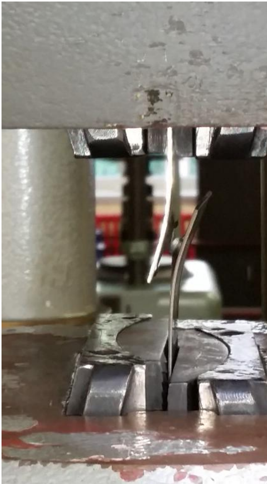
Slika 38. Ispitni uzorak neposredno prije loma
