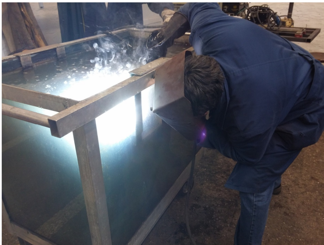
Slika 35. Moko podvodno REL zavarivanje
