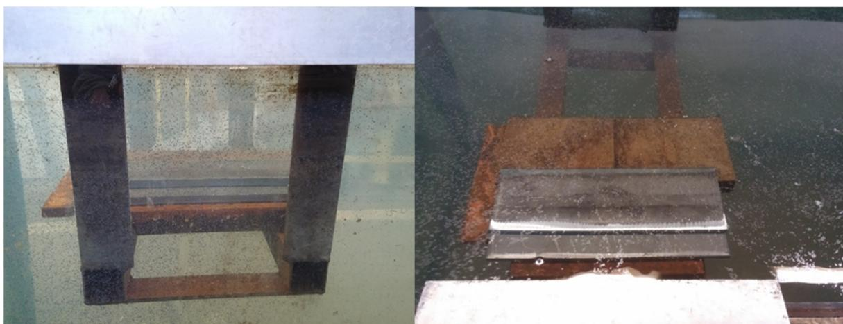
Slika 33. Preklopni spoj pripremljen za podvodno zavarivanje
