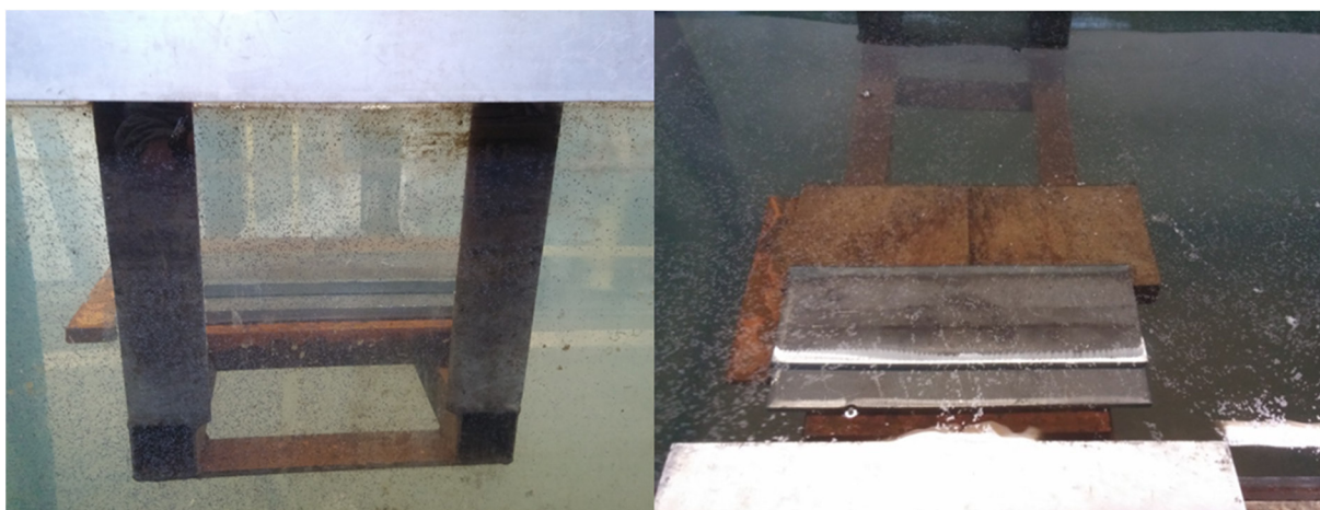
Slika 33. Preklopni spoj pripremljen za podvodno zavarivanje
