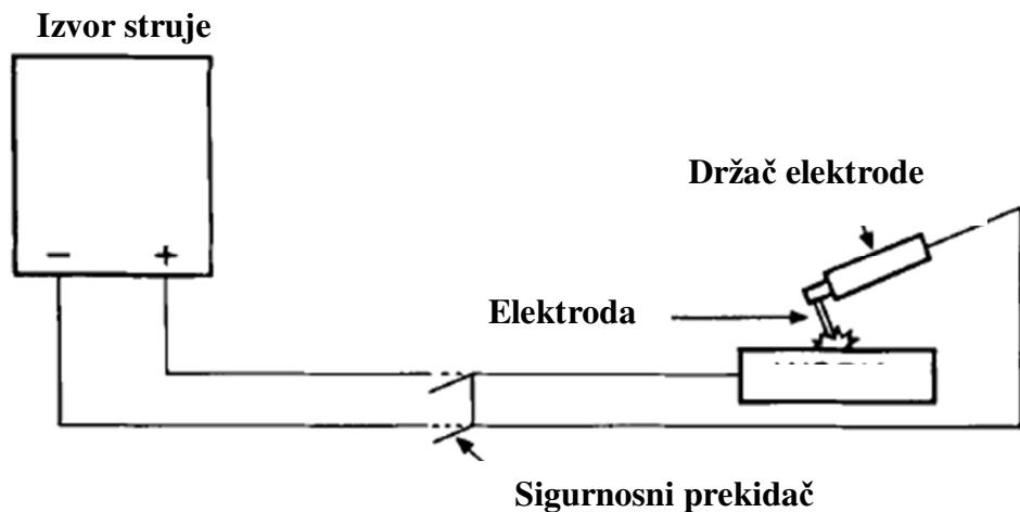
Slika 4. Shematski prikaz REL podvodnog zavarivanja [9]
