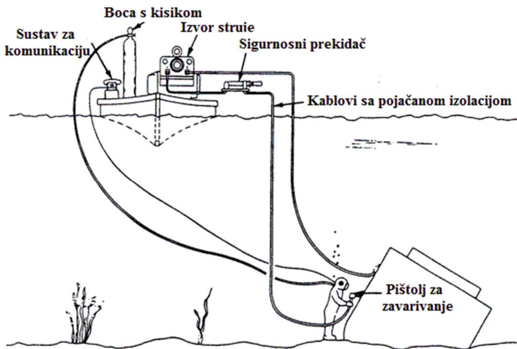
Slika 12. Oprema za mokro podvodno zavarivanje [5]
