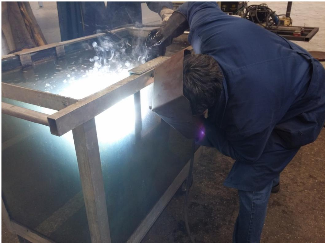
Slika 35. Mokro podvodno REL zavarivanje
