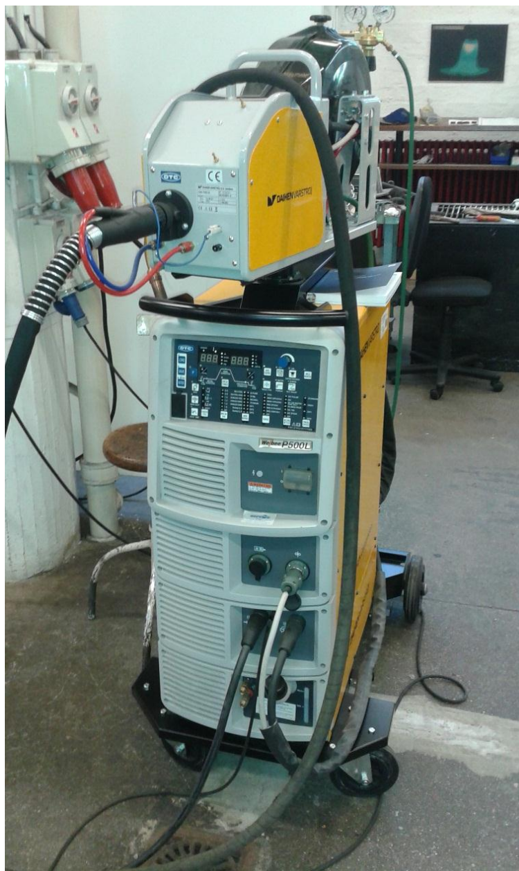
Slika 19. Uređaj korišten za MIG tvrdo lemljenje - Welbee P500L
