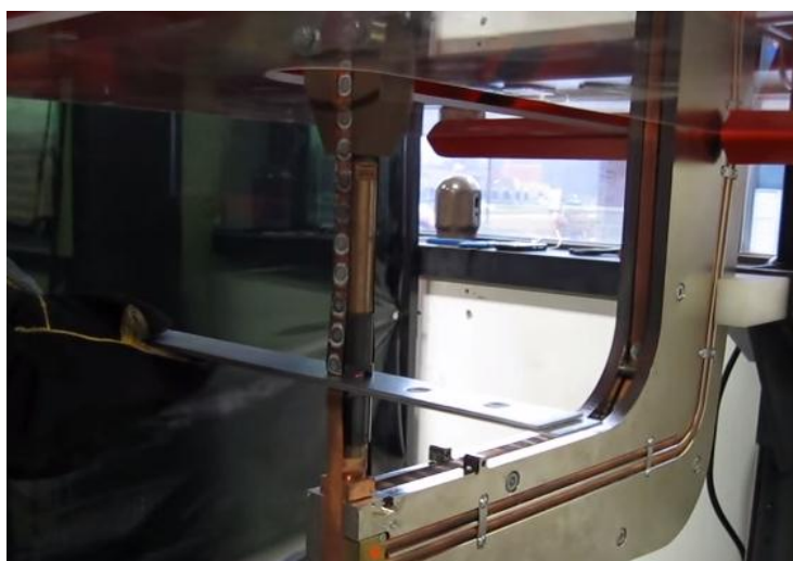
Slika 17. Postupak EO točkastog zavarivanja pocinčanih limova [14]
