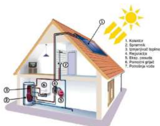
Slika 6. Solarno zagrijavanje potrošne tople vode [8]
