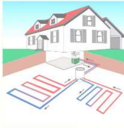
Slika 5. Dizalica topline sa tлом kao izvorom topline [7]
