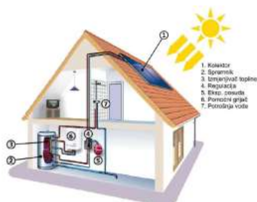
Slika 6. Solarno zagrijavanje potrošne tople vode [8]
