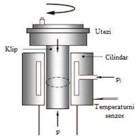
Slika 4.3. Osnovni dijelovi tlačne vase
