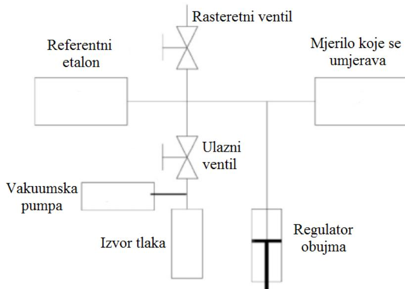
Slika 3.1. Shema za mjerjenje apsolutnog tlaka pomoću EURAMET/cg 17 metode
