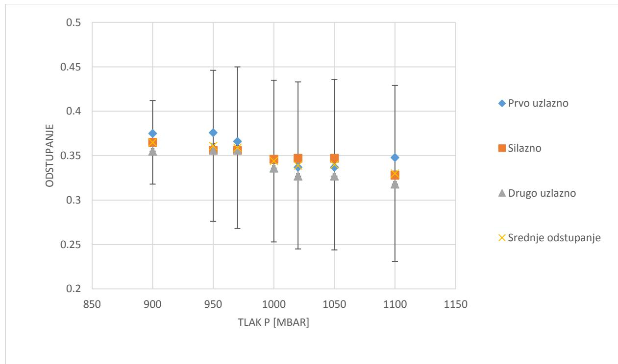
Slika 6.2. Dijagram odstupanja i nesigurnosti umjeravanja u odnosu na mjereni tlak (Vaisala PTB 330)
