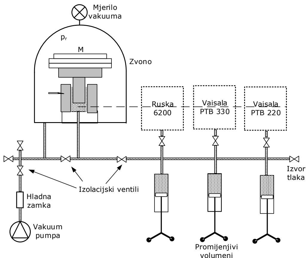
Slika 4.2. Shema mjerne linije za umjeravanje LPM-a
