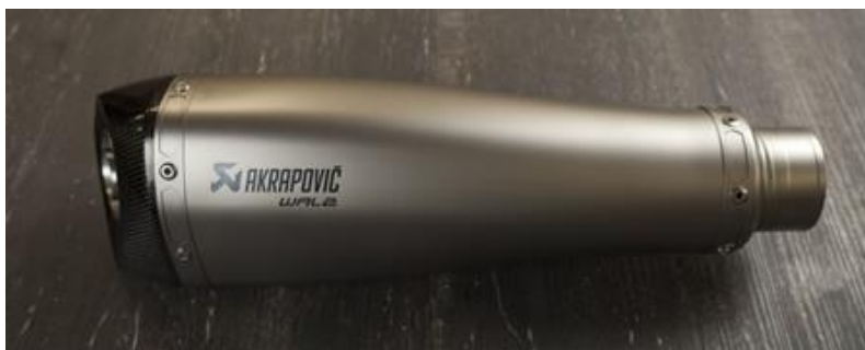
Slika 16. Prigušivač ispušnog sustava od titana [32]
