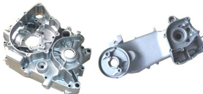
Slika 10. Primjeri dijelova izrađenih tlačnim lijevanjem [21]
