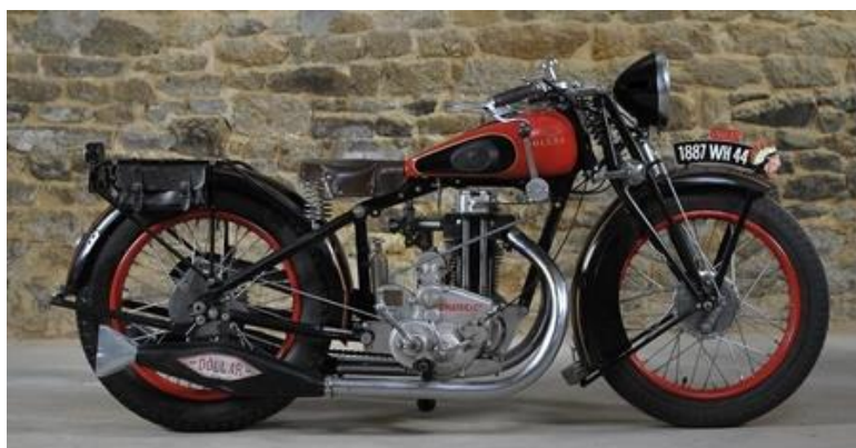
Slika 20. Jednostavan okvir motocikla Dollar S3 iz 1930. godine [41]
