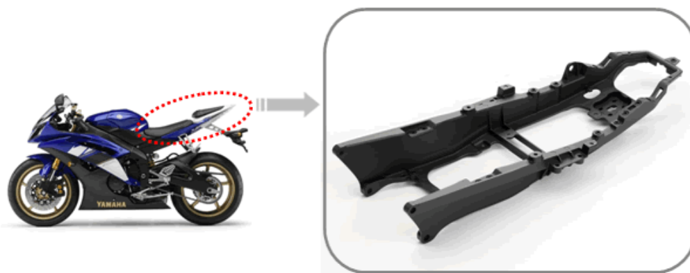
Slika 28. Stražnji podokvir od magnezija s Yamahae YZF-R6 [58]
