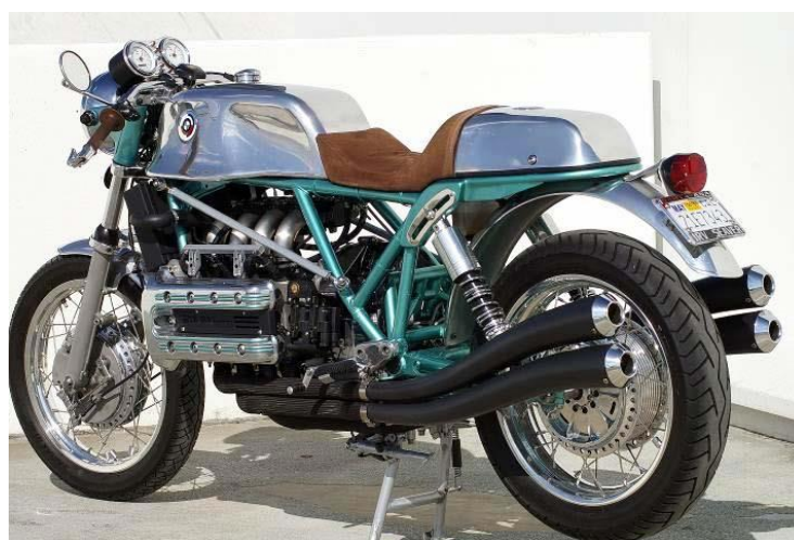
Slika 23. Primjer okvira izrađenog od „chromoly“ čelika [49]
