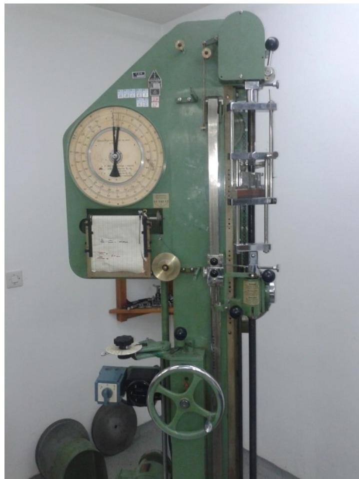
Slika 18. Uredaj za ispitivanje savojne čvrstoće
