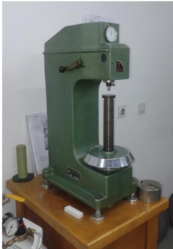
**Slika 33. Uredaj za ispitivanje tvrdoće**
