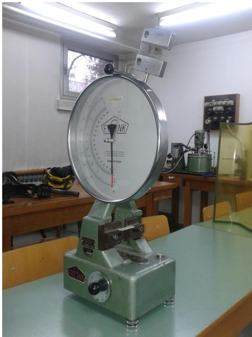
Slika 29. Charpyev bat za ispitivanje žilavosti
