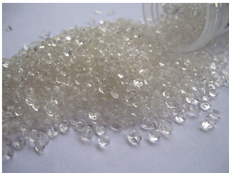
Slika 14. Reciklirane granule PLA [20]
