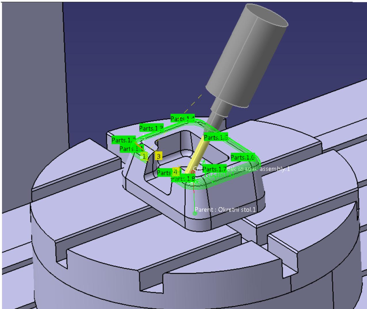
Slika 50 Putanja alata kod operacije "Isoparametric Machining"
