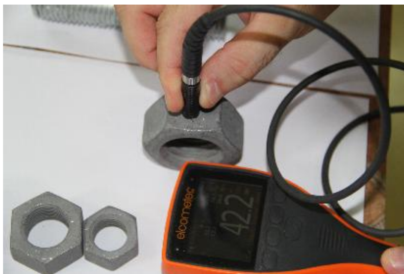
Slika 6.17. Mjerenje debljine prevlake šerardizirane matice [22]
