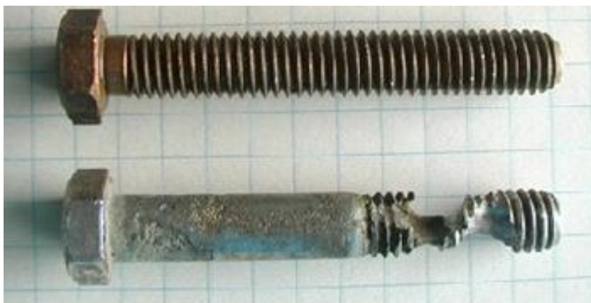
Slika 2.6. Korozija u procjepu [14]
