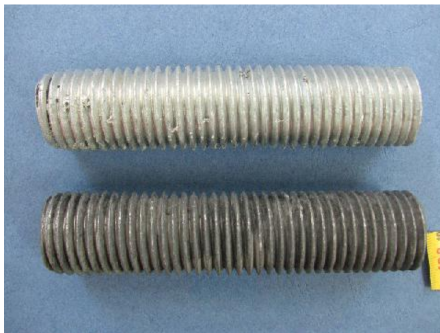
Slika 6.11. Usporedba šerardiziranog i vruće cinčanog vijka [22]
