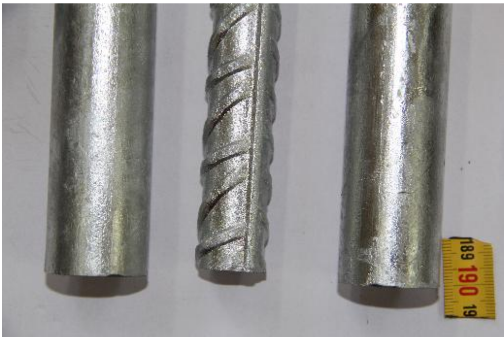
Slika 6.15. Vijci prevučeni postupkom vrućeg cinčanja [22]
