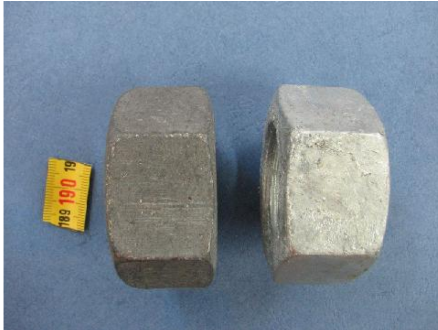
Slika 6.10. Usporedba šerardizirane i vruće cinčane matice [22]
