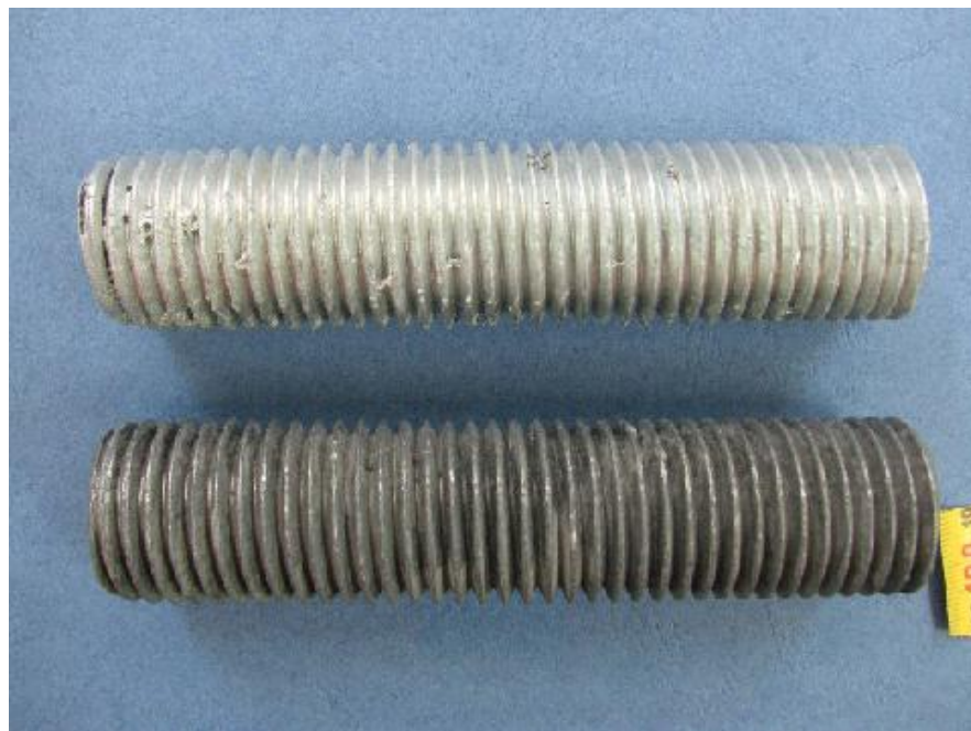
Slika 6.11. Usporedba šerardiziranog i vruće cinčanog vijka [22]
