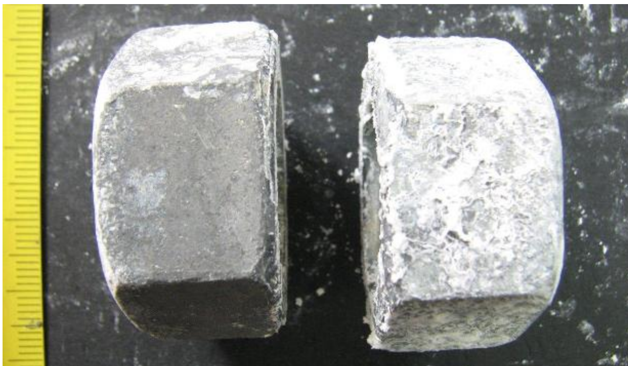
Slika 6.24. Usporedba šerardizirane i vruće cinčane matice [22]
