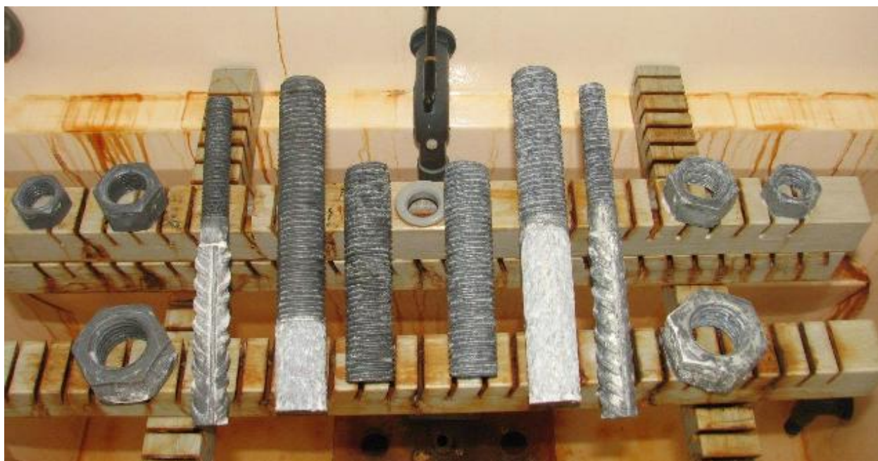
Slika 6.22. Stanje uzoraka nakon 72 sata provedena u slanoj komori [22]
