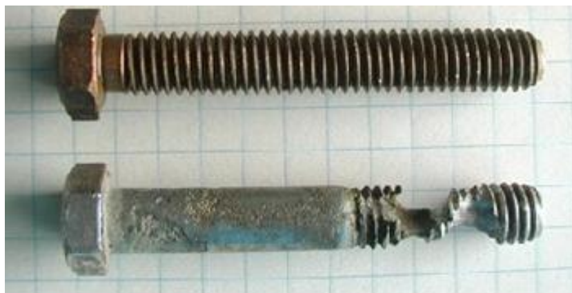
Slika 2.6. Korozija u procjepu [14]
