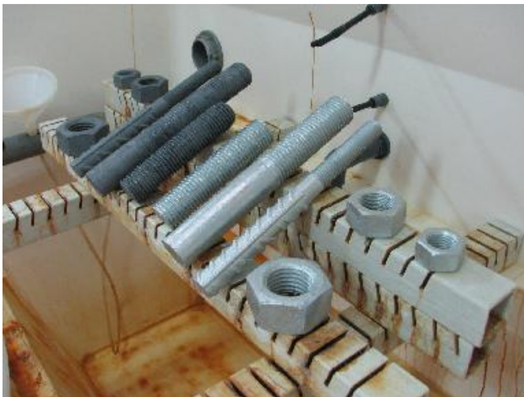
Slika 6.18. Raspored uzoraka u slanoj komori [22]
