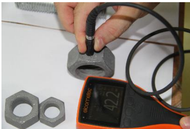
Slika 6.17. Mjerenje debljine prevlake šerardizirane matice [22]
