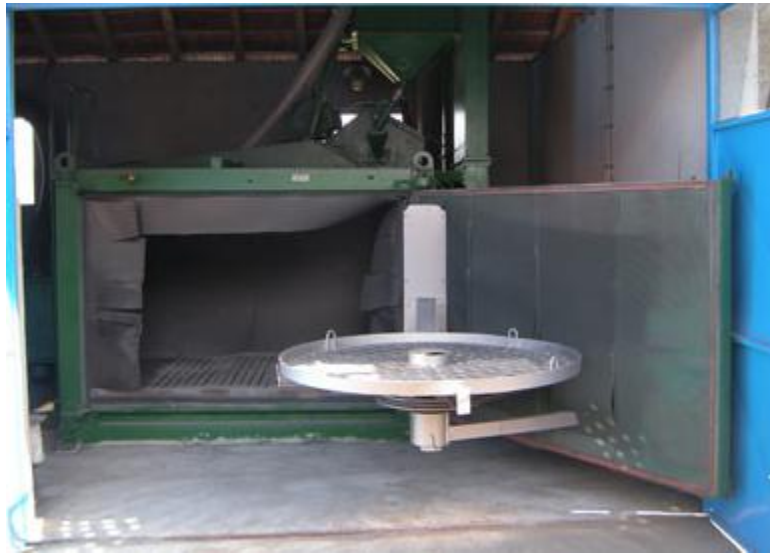
Slika 3.4. Uređaj za sačmarenje krupnih obradaka na rotirajućem stolu [21]
