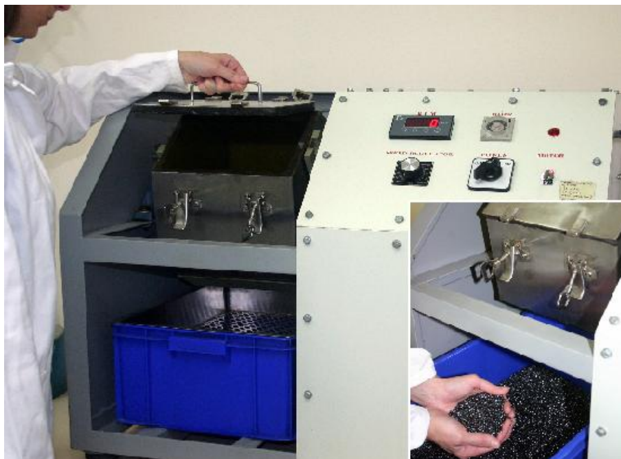
Slika 3.2. Vibracijski uređaj za čišćenje i poliranje [19]
