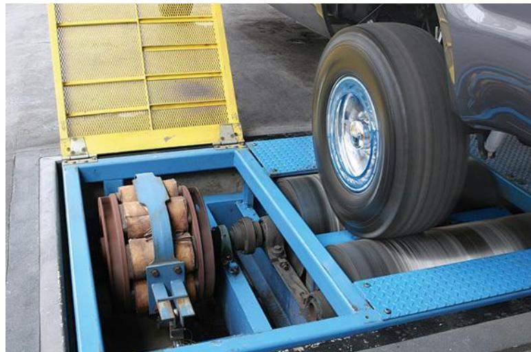
**Slika 3. Valjci za mjerjenje snage**
