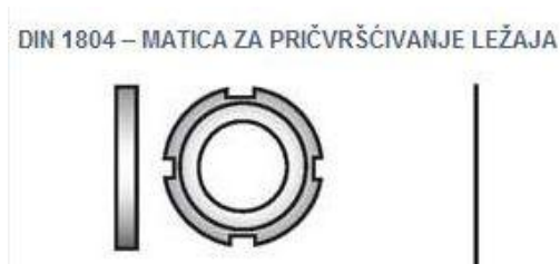
Slika 37. Matica za pričvršćivanje ležaja
