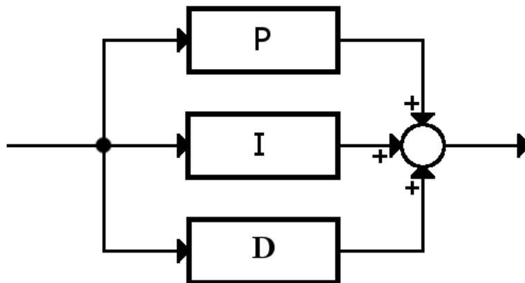
Slika 13. Blok dijagram paralelene forme PID regulatora
