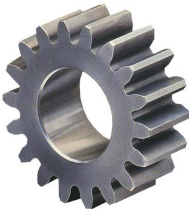
Slika 1.1 Zupčanik sa ravnim zubima i evolventnim ozubljenjem; [1]
