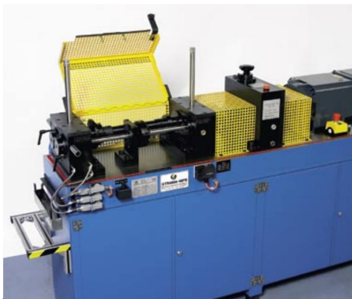
Slika 2.2 Realna izvedba FZG uređaja; [5]
