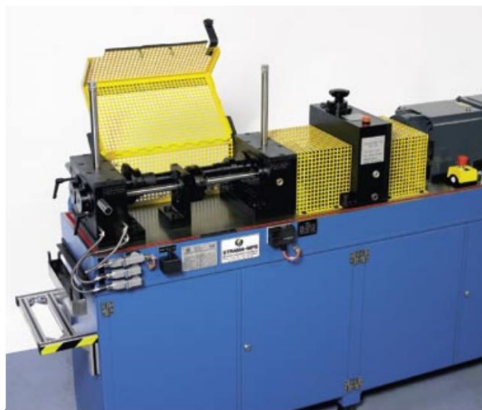
Slika 2.2 Realna izvedba FZG uređaja; [5]
