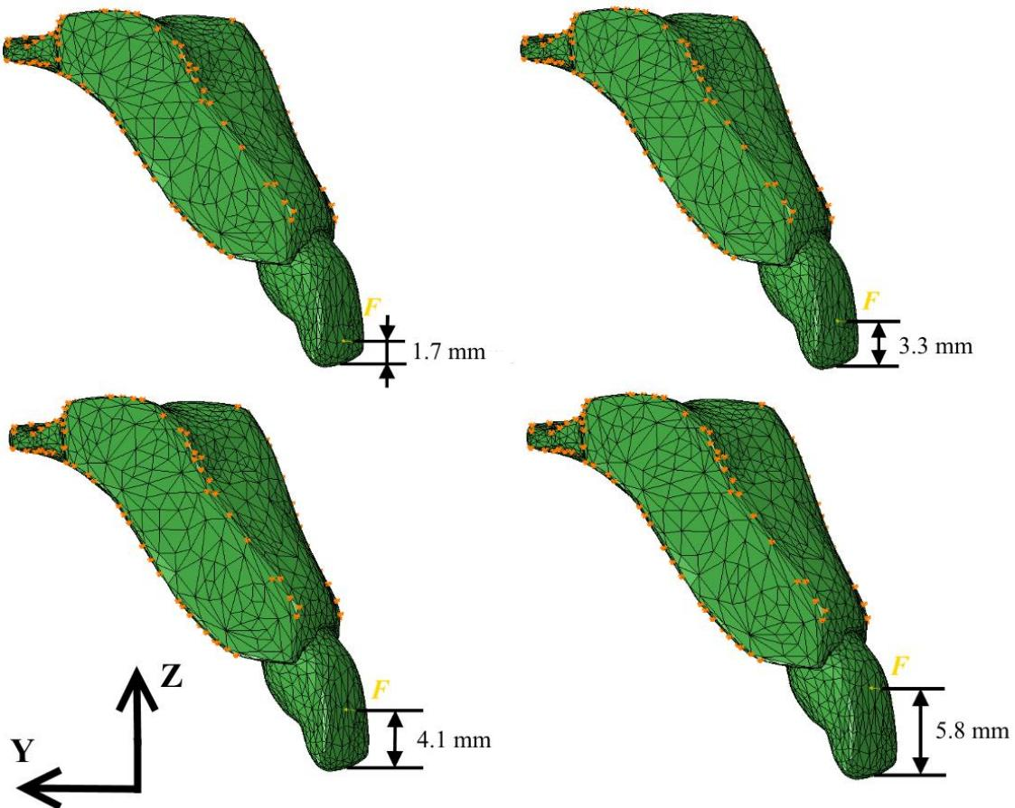
**Slika 2.7. Udaljenosti hvatišta sila od vrha krune zuba**
