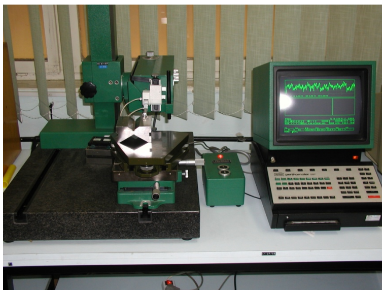
Slika 21. Elektromehanički uređaj za ispitivanje hrapavosti površine MU2-127
