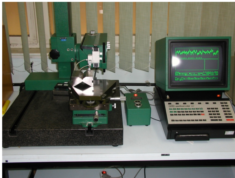
Slika 21. Elektromehanički uređaj za ispitivanje hrapavosti površine MU2-127
