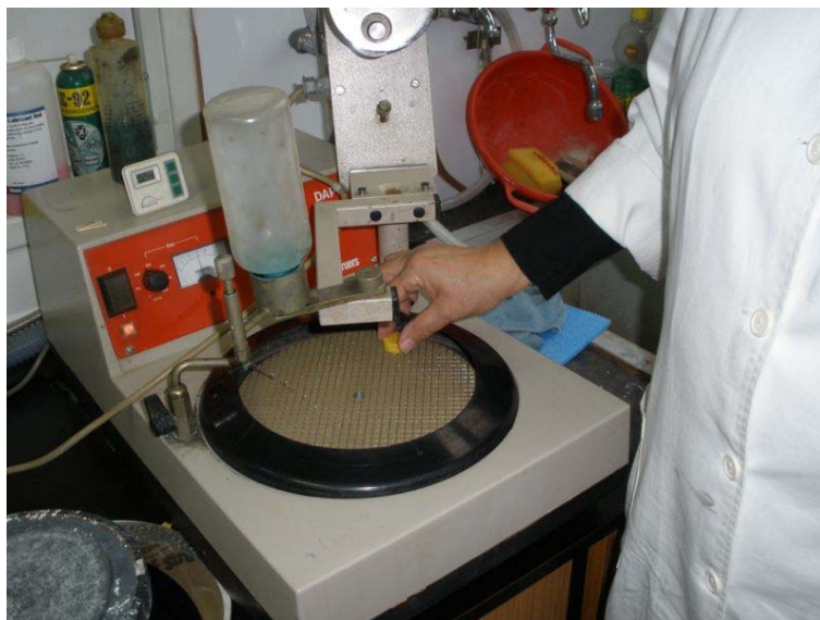
Slika 15. Uređaj za brušenje i poliranje keramike
