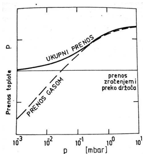
Slika 22. Prikaz udjela prijenosa topline u ovisnosti o tlaku plina
