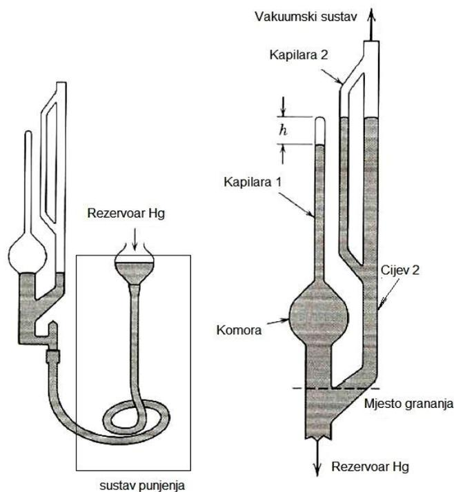
Slika 6. McLeodov vakuummetar
