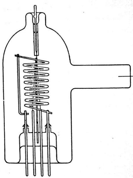
**Slika 26. Ionizacijska trioda s katodom oblika ukosnice**
