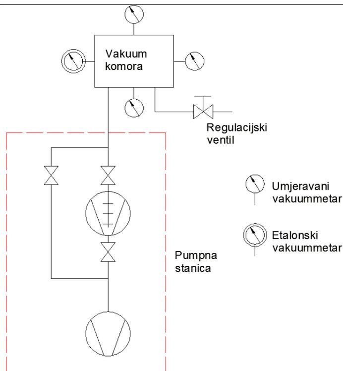
**Slika 34. Prijedlog sustava za umjeravanje metodom sekundarnog standarda**
