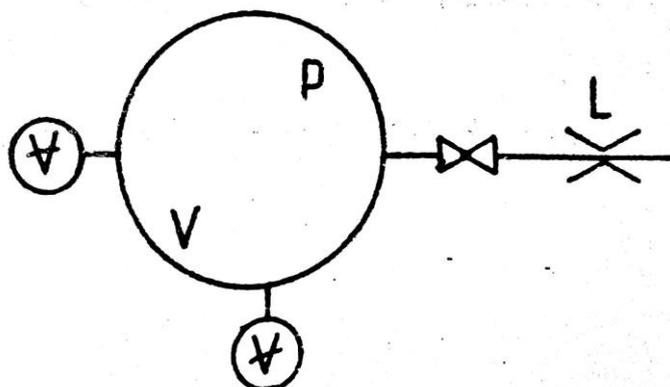
**Slika 28. Shema sustava za umjeravanje metodom opadanja tlaka**
