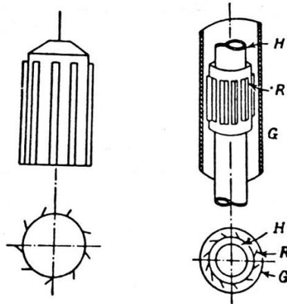
Slika 17. Columb – Schwarz vakuummetar
