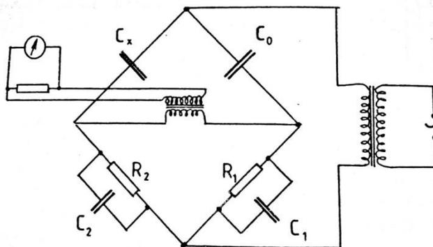
Slika 12. Shema kapacitivnog mosta za mjerenje kapaciteta vakuummetara
