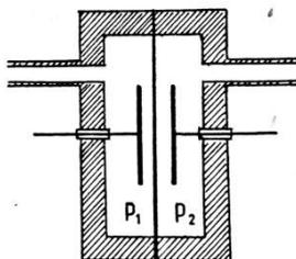
Slika 11. Kapacitivni vakuummetar
