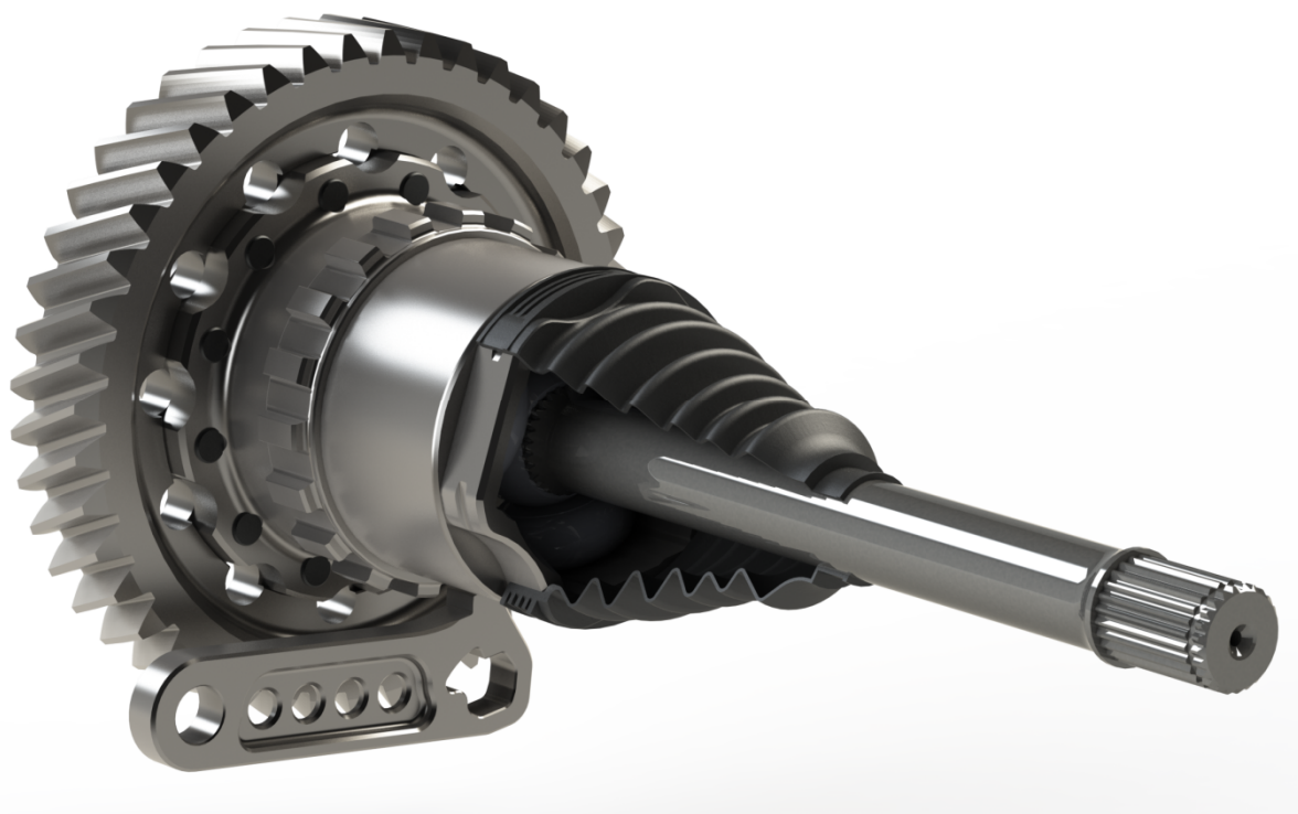
Slika 37: Integrirano kućište sinkronog zgloba (tripoida) – CAD model
