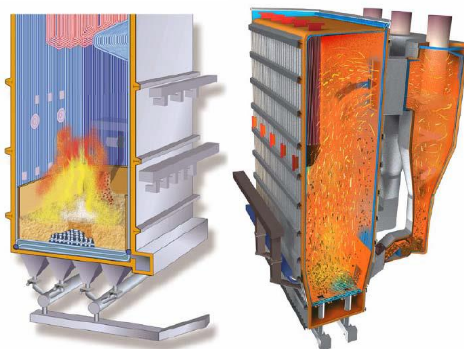
Slika 4. Presjek ložišta s izgaranjem u fluidiziranom sloju: mehurica (lijevo) i cirkulirajući (desno) [6]
