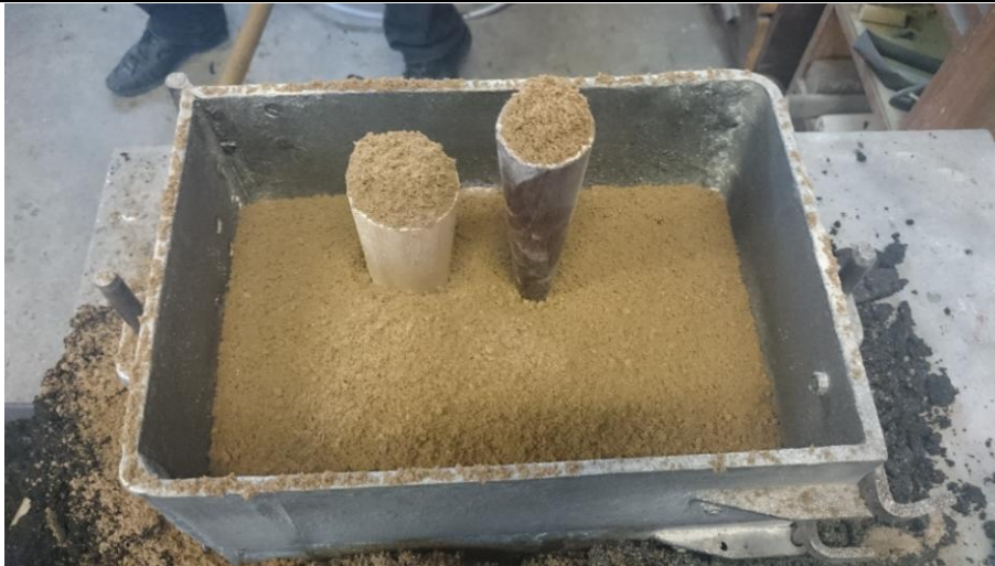
Slika 51. Nasipavanje pijeska u gornjak
