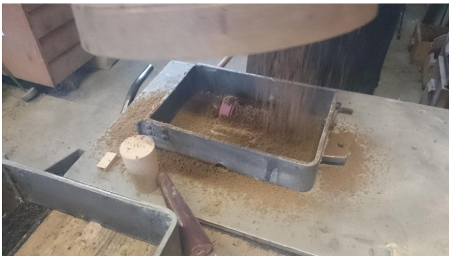
Slika 46. Nasipavanje pijeska u donjak
