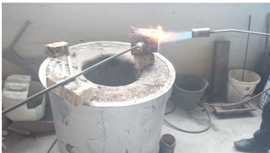
Slika 59. Zagrijavanje lonca za ulijevanje
