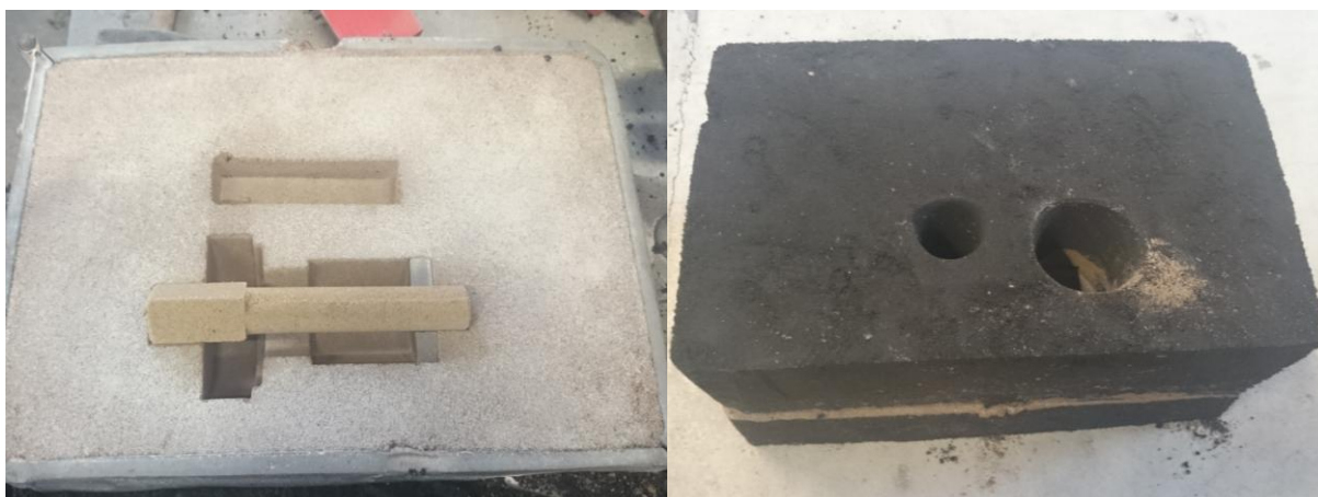
Slika 57. Jezgra (lijevo) i gotovi kalup (desno)
