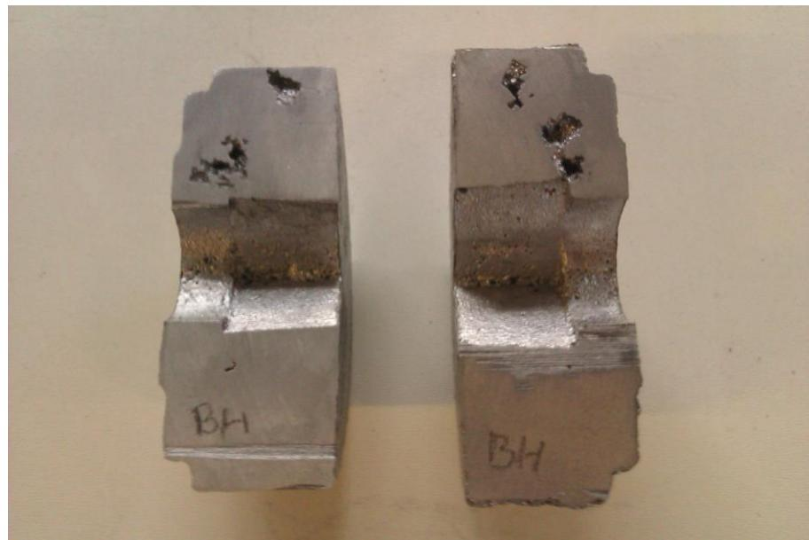
Slika 67. Poroznost u odljevku lijevanom bez hladila
