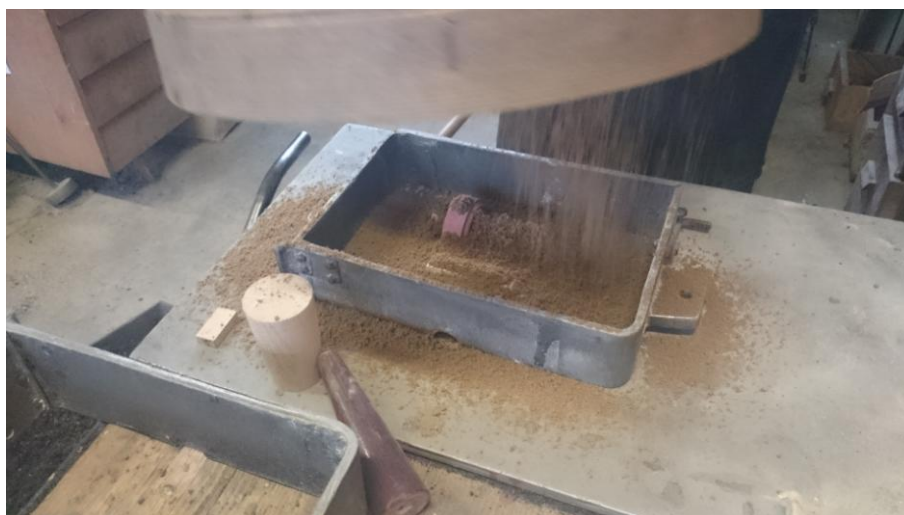
Slika 46. Nasipavanje pijeska u donjak
