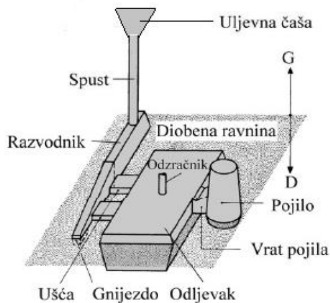
Slika 7. Uljevni sustav
