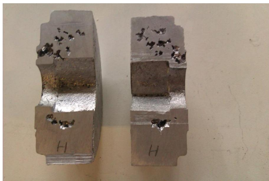
Slika 68. Poroznost u odljevku lijevanom s hladilom
