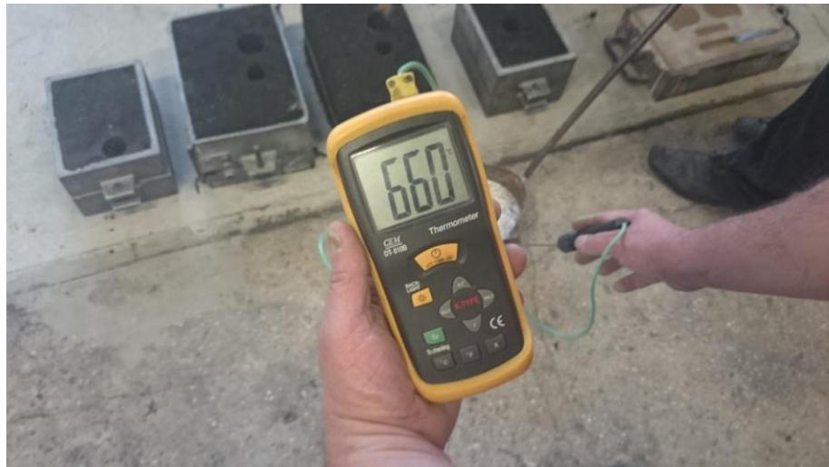
**Slika 60. Temperatura lijevanja**
