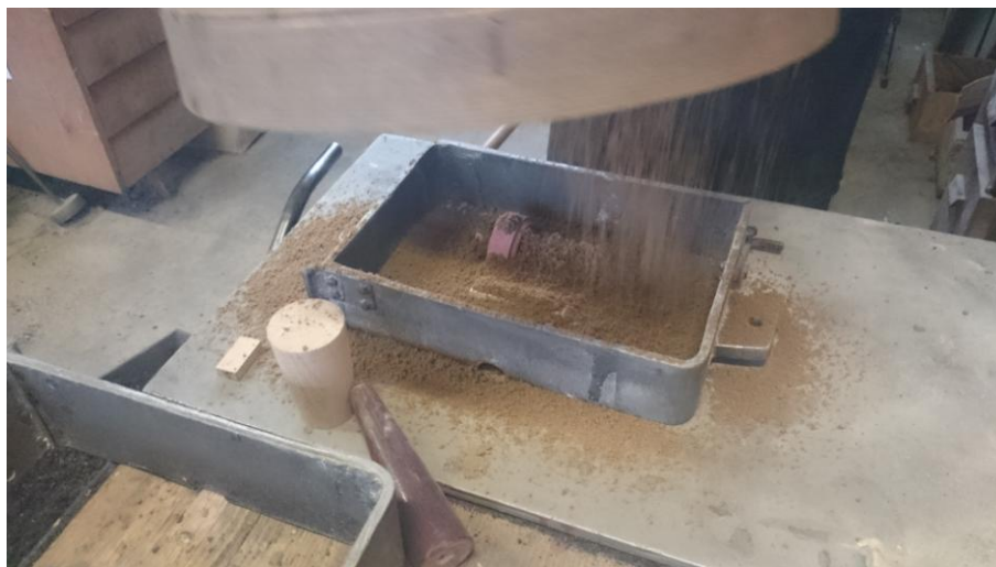
Slika 46. Nasipavanje pijeska u donjak
