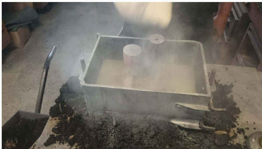
Slika 50. Posipavanje likapodijem gornjaka
