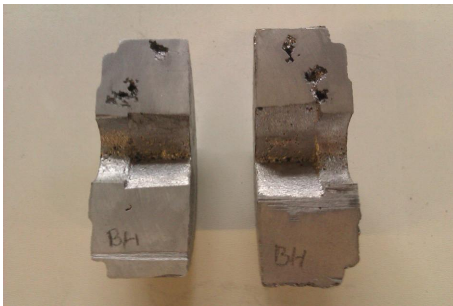
Slika 67. Poroznost u odljevku lijevanom bez hladila
