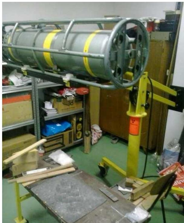
Slika 65. Rentgen u Laboratoriju za nerazorna ispitivanja
