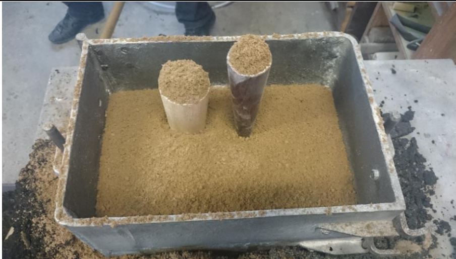
Slika 51. Nasipavanje pijeska u gornjak
