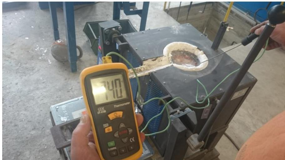
Slika 58. Temperatura taljevine u peći
