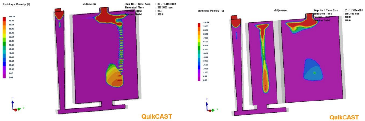
Slika 24: Vjerojatnost pojave poroznosti u odljvcima s ulijevanjem odozdo
