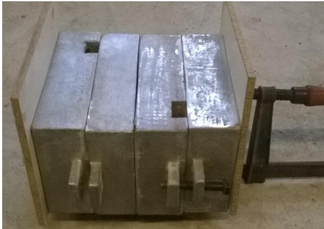
Slika 51: Izgled kalupa spremnih za lijevanje za vertikalni uljevni sustav
