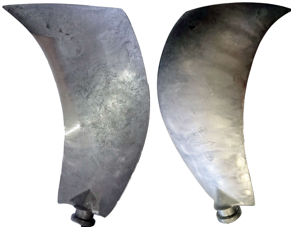
Slika 2.1: Srpasta lopatica analiziranoga ventilatora.
