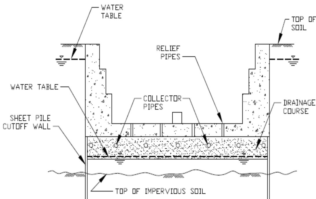
**Slika 26. Poprečni presjek doka koji je djelomično oslobođen hidrostatičkog tlaka [4]**
