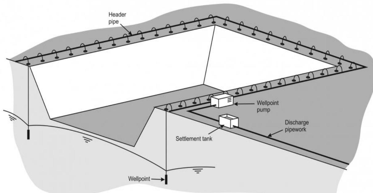
**Slika 18. Princip rada well point sustava za isušivanje [14]**
