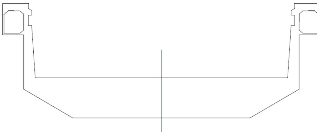
**Slika 47. Poprečni presjek doka koji se koristi za strukturnu analizu**
