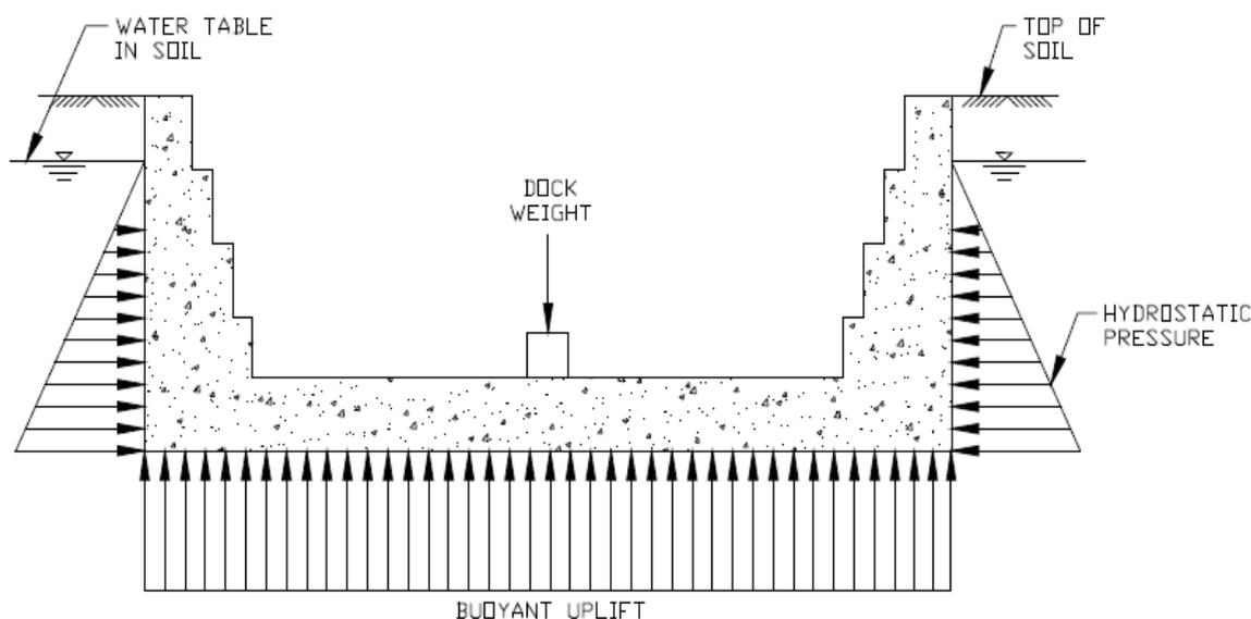
**Slika 19. Djelovanje hidrostatičkog tlaka na suhi dok [4]**
