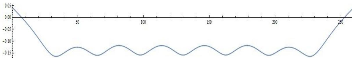
**Slika 55. Deformacije nastale uslijed djelovanja sila na podijeljenih osam elemenata**
