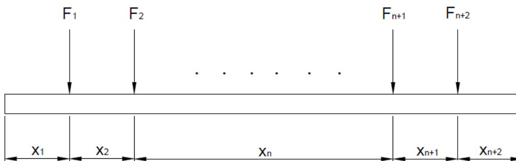
**Slika 53. Struktura opterećena sa n brojem sila**
