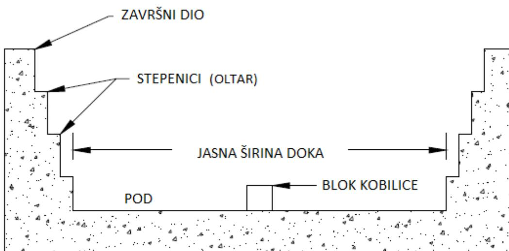
Slika 5. Poprečni presjek suhog doka s oltarima [4]
