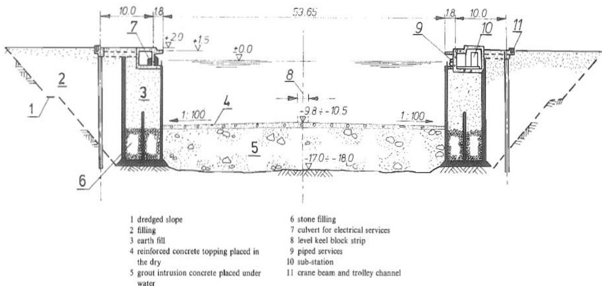
**Slika 22. Presjek betonsko-masivnog suhog doka u Scaramangi [8]**
