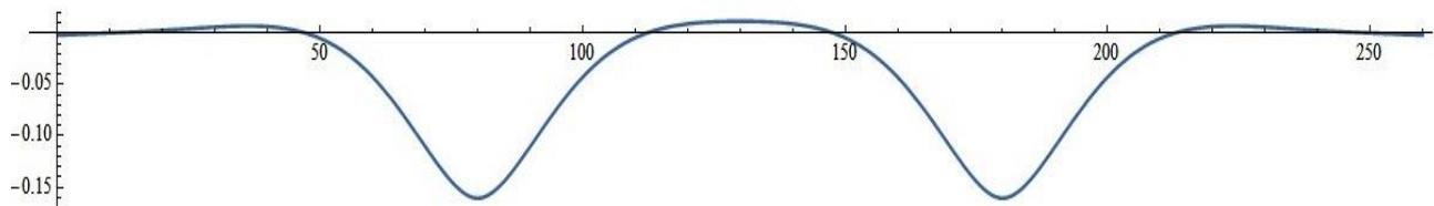
**Slika 52. Deformacija nastala uslijed djelovanja dvije koncentrirane sile određenog iznosa**
