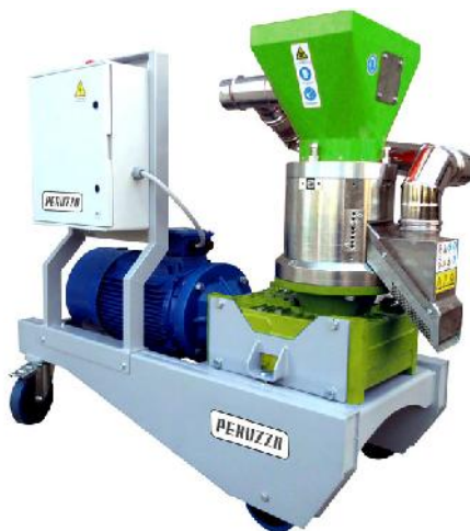
Slika 13. Peletirka Peruzzo Minipel E300 [13]
