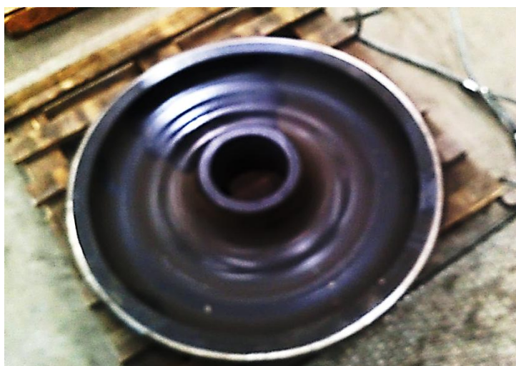
Slika 45. Monoblok kotač s istrošenim vijencem
